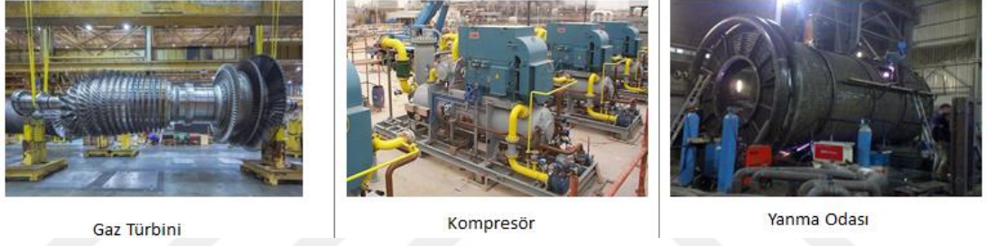
Şekil 2.3. Gaz türbini, kompresör ve yanma odası
