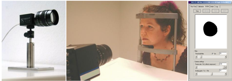
Şekil 1.9. Kafa sabitleyici kullanılarak görüntüye dayalı göz takip sistemi [14]
