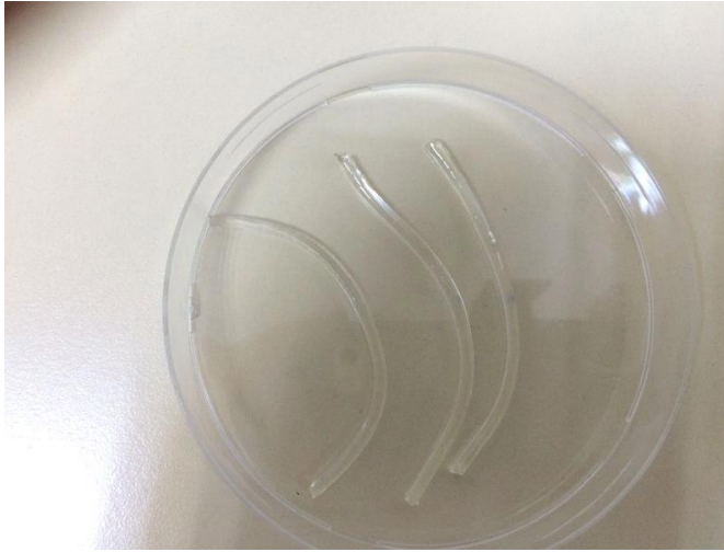
Őekil 3.1: Sentezlenen polimerin silindirlerden ıkarılmıř jel hali
