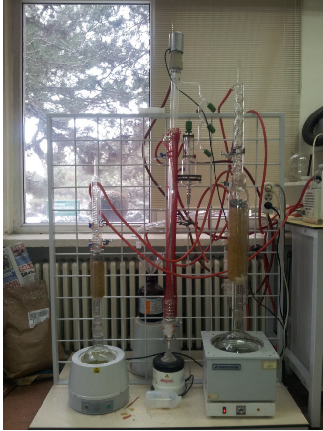
Şekil 2.2. Soxhlet apereyinde ekstrelerin elde edilmesi
