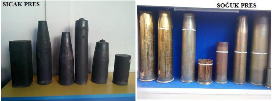
Şekil 1.1. Sıcak preslenmiş ve soğuk preslenmiş mühimmatlar
