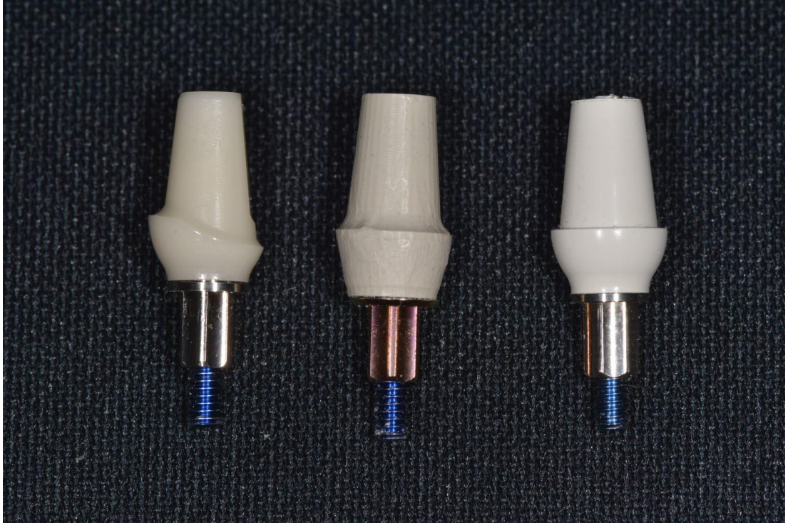
Şekil 2.1: Sırasıyla (soldan sağa) titanyum alt yapılı Zirkonyum, PEKK ve Güçlendirilmiş PEEK implant dayanaklar
