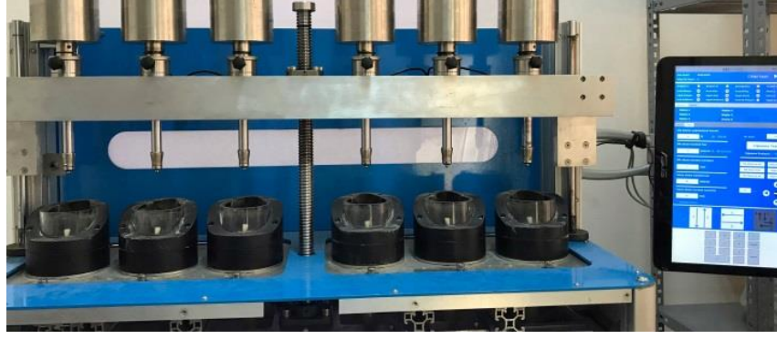
Şekil 2.17: Çift akslı çiğneme simülatörü (MOY 101 Çiğneme Simülatörü, MOD Dental, Esetron Smart Robotechnologies, Ankara, Türkiye)
