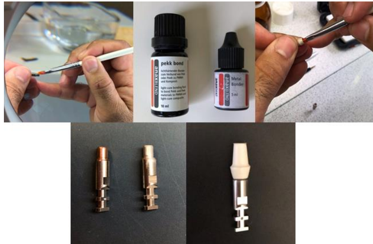
Şekil 2.5: Üretilen PEKK dayanak materyalinin analog üzerine vidanlanmış titanyum alt yapı üzerine simantasyon aşamaları
