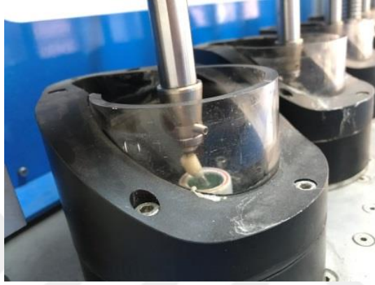
Şekil 2.16: Örneklerin çiğneme simülatörüne yerleştirilmesi ve antagonist ucun hizalanması
