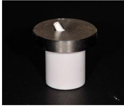
Şekil 2.7: Metal plaka yardımıyla örneklerin plastik tutucu içindeki akrilik rezine gömülmesi
