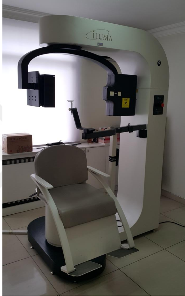
Şekil 2. 1 Konik Işınlı Bilgisayarlı Tomografi Cihazı (ILUMA, IMTEC Europa, Oberursel, Almanya) Tomoloji Maksillo Fasiyal Görüntüleme Merkezi Ankara.
