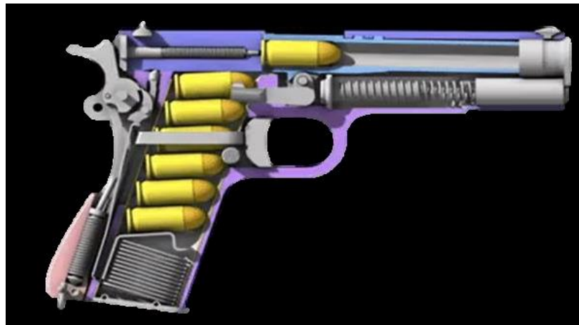
Şekil 3.1. Otomatik tabanca çalışma prensibi[17]
