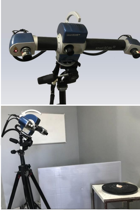
Şekil 3.19. SmartScan (Breuckmann, Meersburg, Germany) 3 boyutlu tarayıcı
