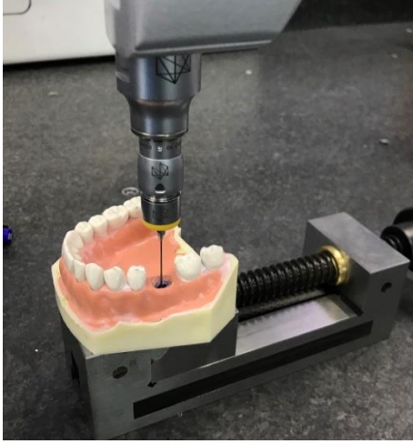
Şekil 3.2. CMM ile implant pozisyonlarının kontrolü
