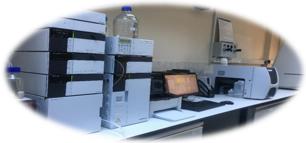
Şekil 2.1. İyon kromatografi Cihazı (Shimadzu-HIC 20A Super, Japonya)
