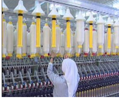
Resim 4.6. Ring makinesinde kopan fitilin bağlanması (T.C. MEB Tekstil Teknolojisi Ring Makinesi 54TGD485)
