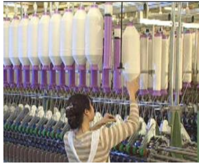
Resim 4.5. Ring makinesinde işlem gören fitil (T.C. MEB Tekstil Teknolojisi Ring Makinesi 54TGD485)
