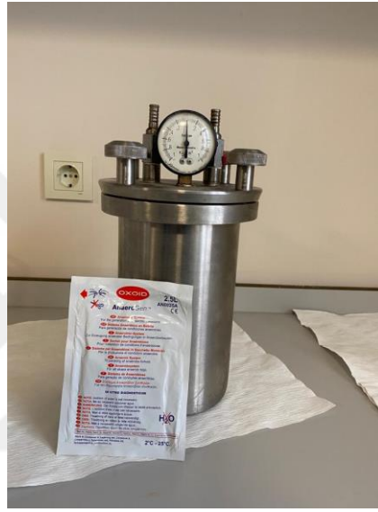
Şekil 1.3. MRS Agar İçeren Petrilerin Konulacağı Anaerobik Jar ve Anaerob Ortamı Sağlayacak Anaerogen
