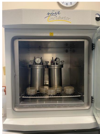
Şekil 2.4. MRS ve PCA Agarlara Ekilen Numunelerin İnkübatördeki Görüntüsü
