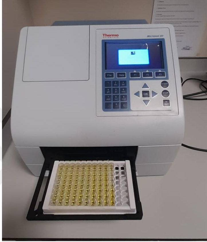
Şekil 2.1. Ticari olarak satın alınan ADM kit protokolü uygulandı ve multiskango spektrofotometre cihazı ile absorbans ölçüldü. (orijinal)
