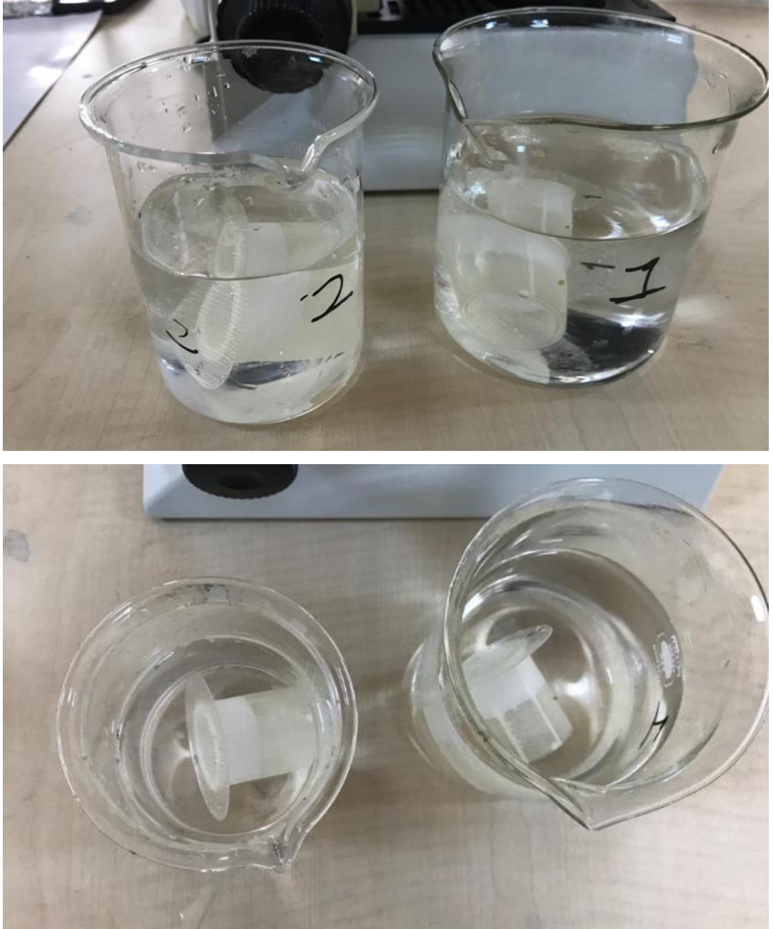
Şekil 3.4. PVA numunesinin çözünmesi işlemi
