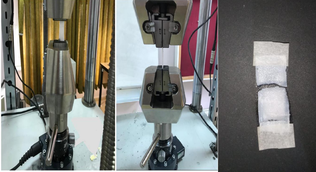
Şekil 3.9. Çekme testi örneği ve kopma anının fotoğrafı
