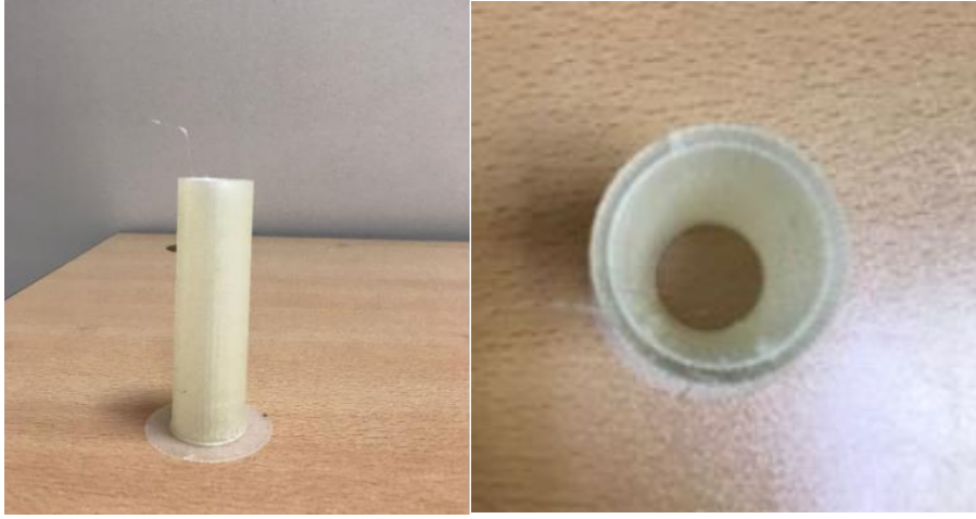
Şekil 2.2. Eklemeli imalat yöntemiyle üretilen PVA kalıp
