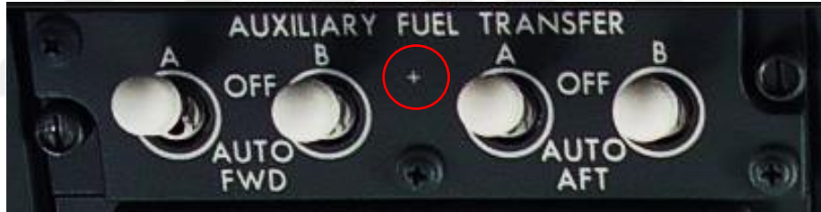
Şekil 27. Örnek Kontrol Paneli Üzerindeki "+" İşareti
