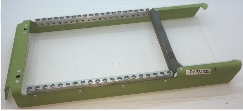
Şekil 23. DZUS Rayı, Hava Aracı Panel Bağlantı Arayüzü
