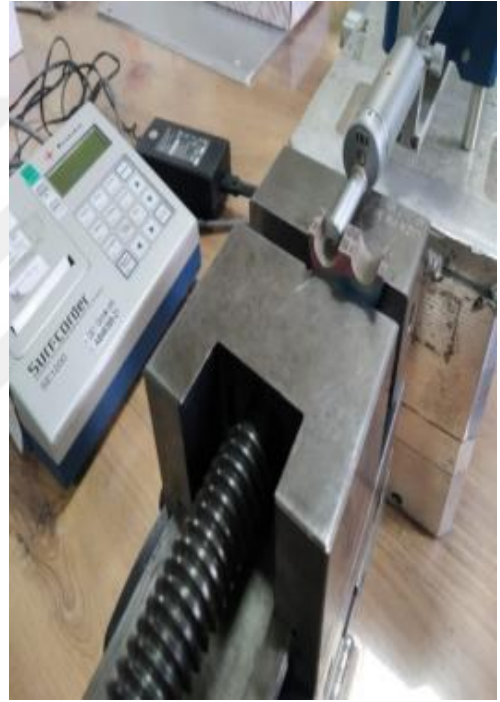
Şekil 1.4. Profilmetre ile yüzey pürüzlülüğü ölçümü
