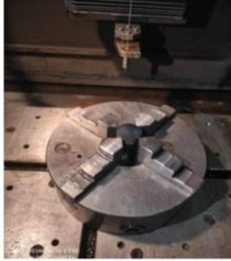
Şekil 2.6. Ti-6Al-4V malzemeye tel erozyonda delik delme
