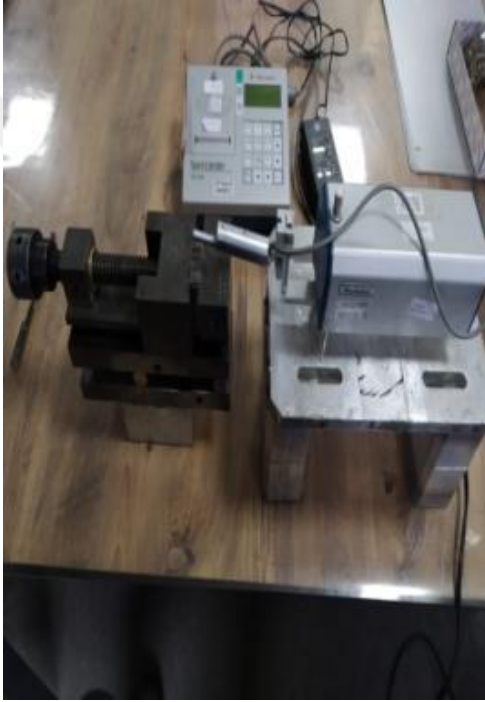
Şekil 1.3. Ti-6Al-4V malzemesinin yüzey pürüzlülüğü ölçümü
