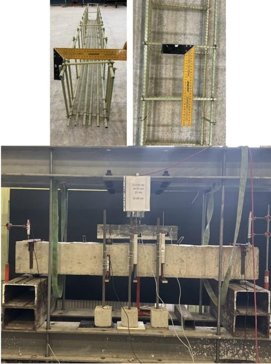
Şekil 30. T-200-2.6 deney elamanı ve elemanın donatı detayları
