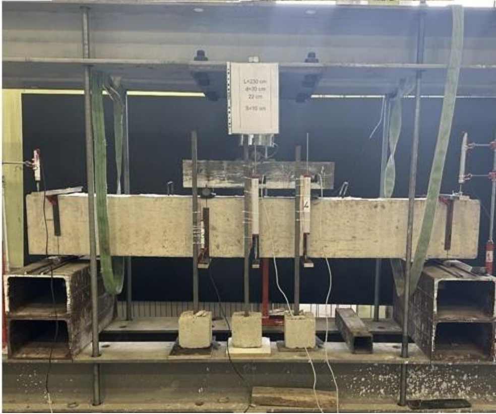
Şekil 28. T-100-2.6 deney elamanı ve elemanın donatı detayları
