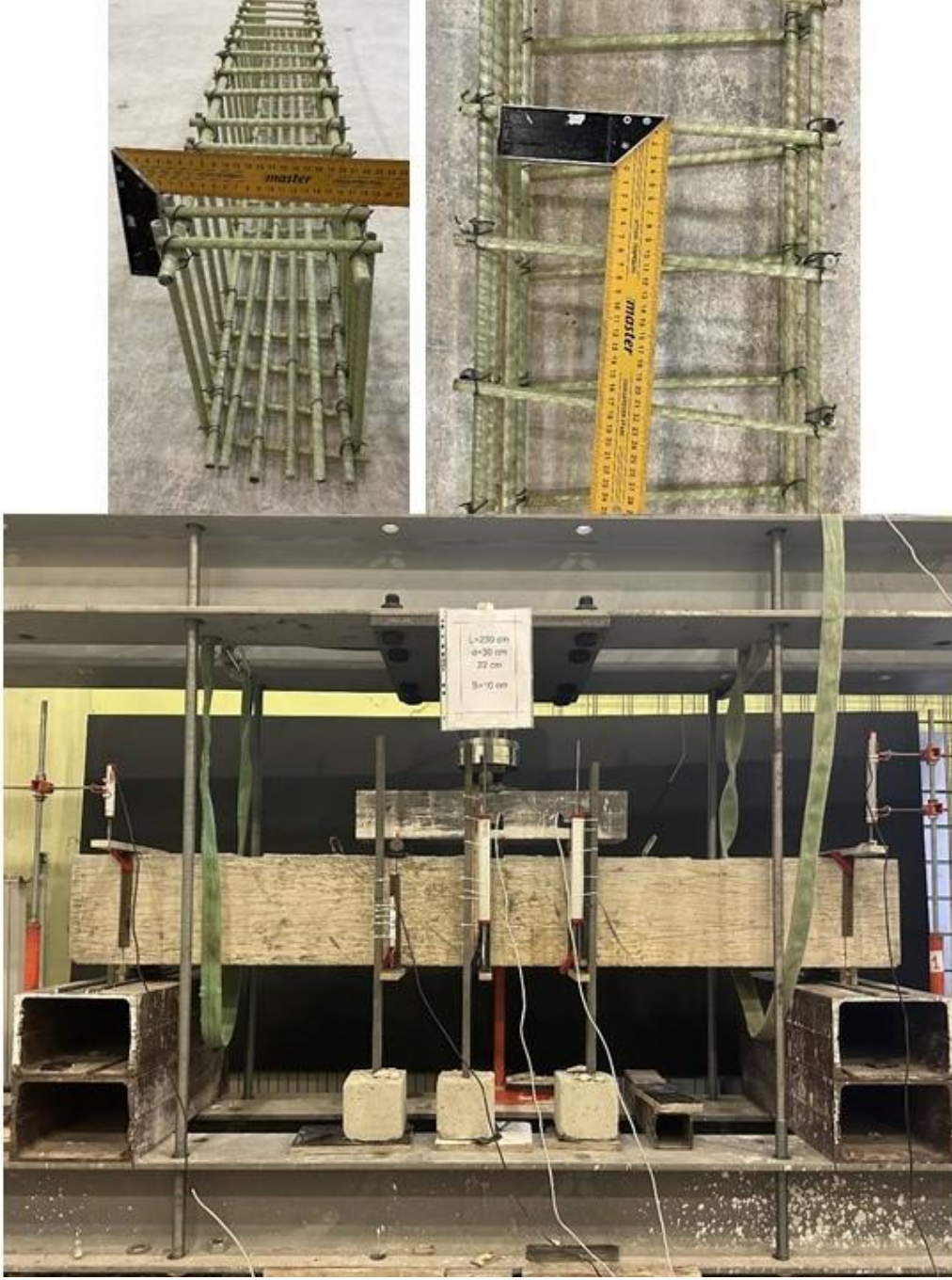
Şekil 24. S-100-2.6 deney elemanı ve elemanın donatı detayları
