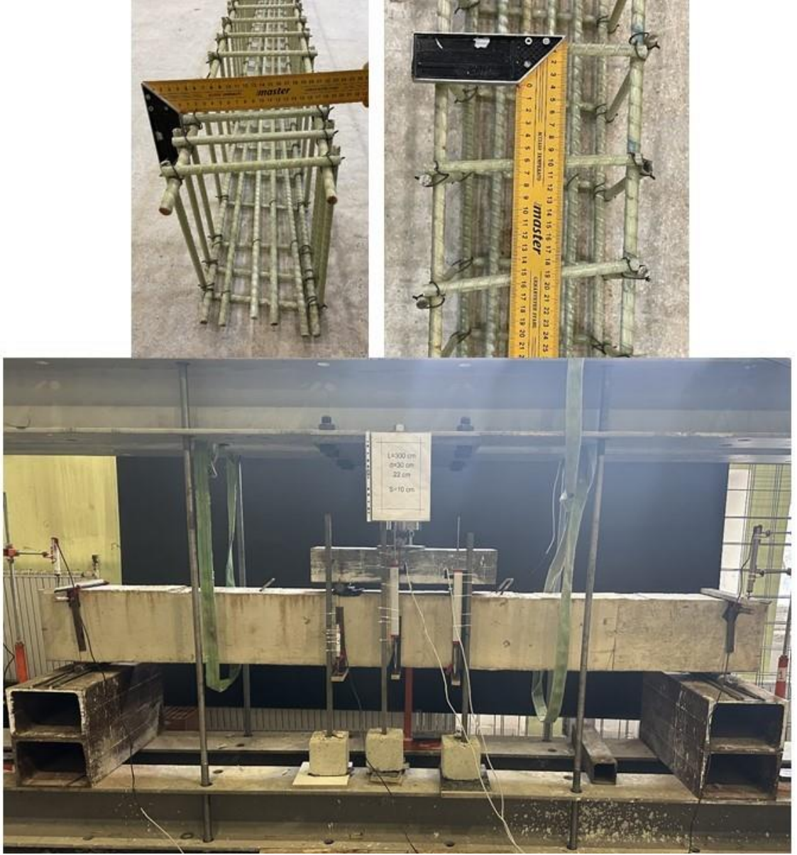
Şekil 20. S-100-3.8 deney elamanı ve elemanın donatı detayları
