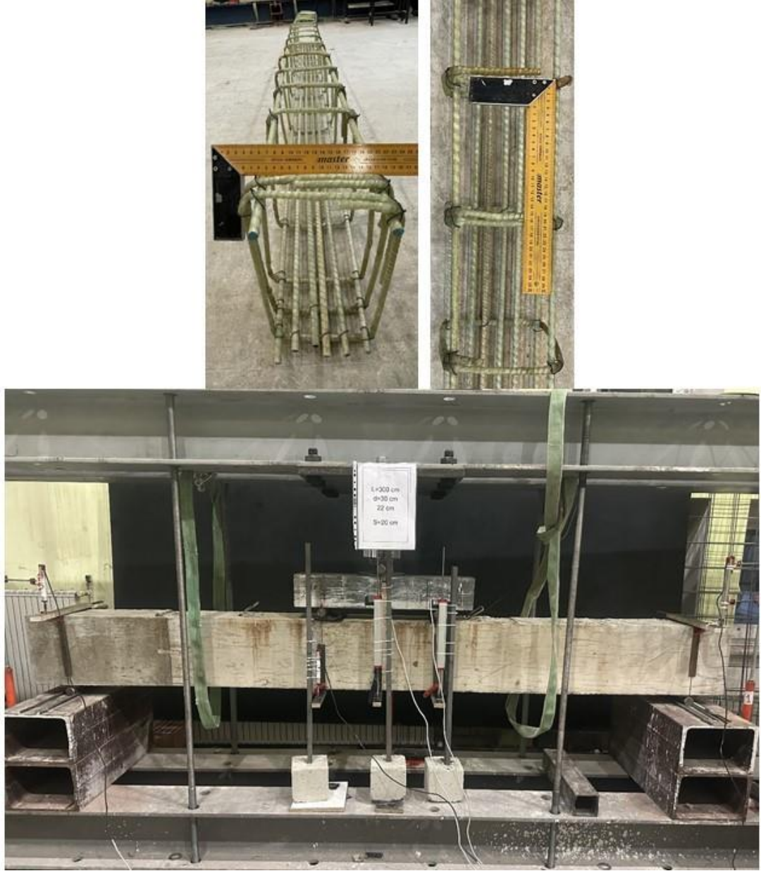
Şekil 14. F-200-3.8 deney elemanı ve elemanın donatı detayları
