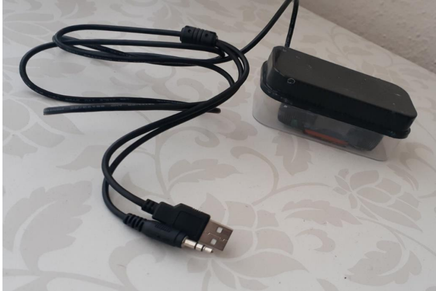
Şekil 4.2. Sızdırmaz kap ve usb kamera
