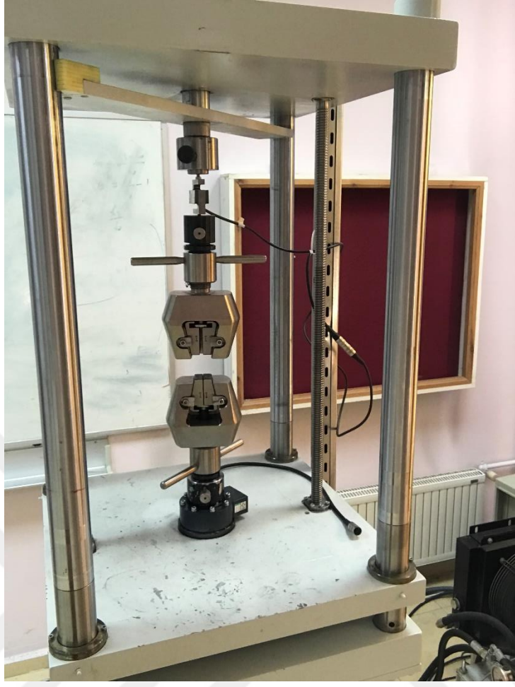
Şekil 3.7. Dinamik Yorulma Test Cihazı Utest (UTM 9000; USA)
