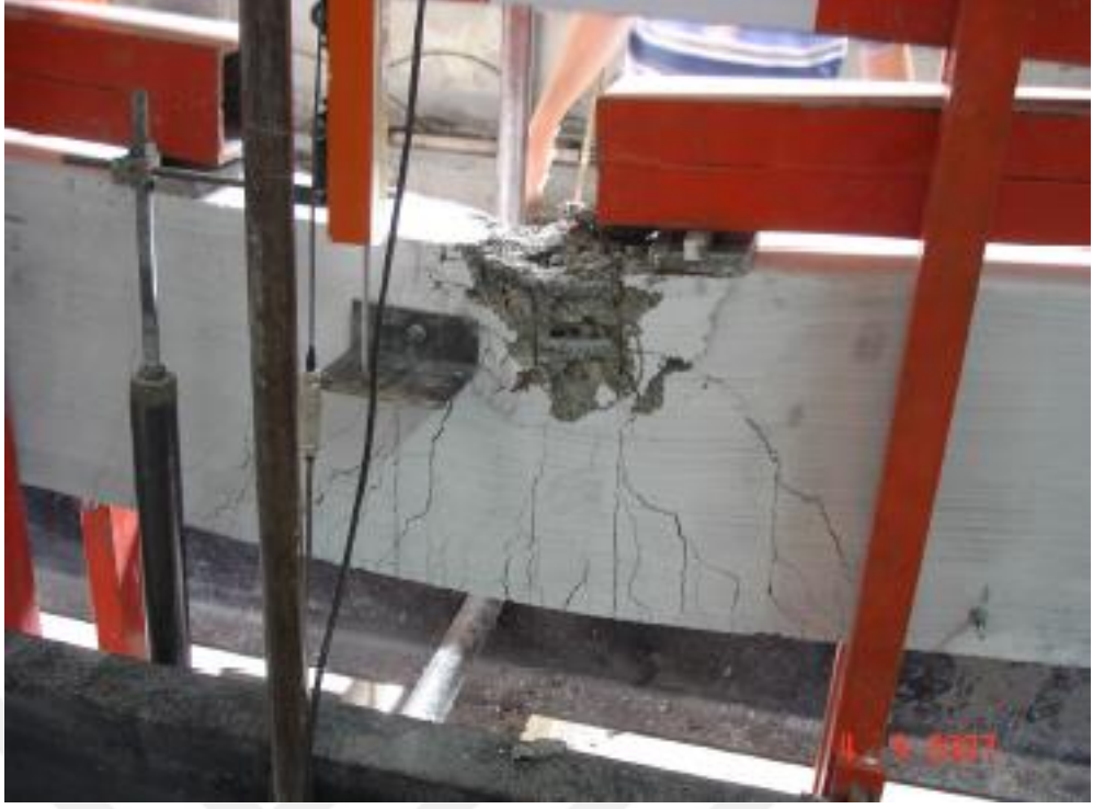
Şekil 3.10. RBb elemanın deneyisel göçme modu [1]
