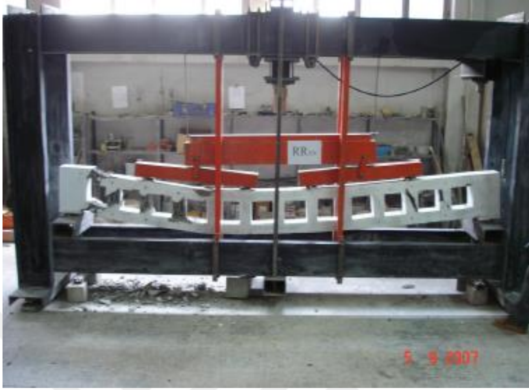
Şekil 3.13. RRxn elemanının deneysel göçme modu [1]
