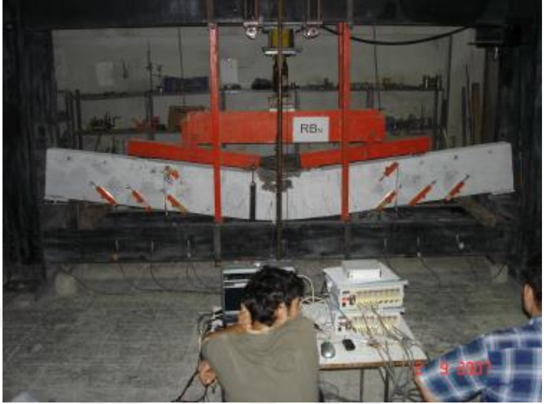
Şekil 3.7. RBn elemanın deneysel göçme modu [1]
