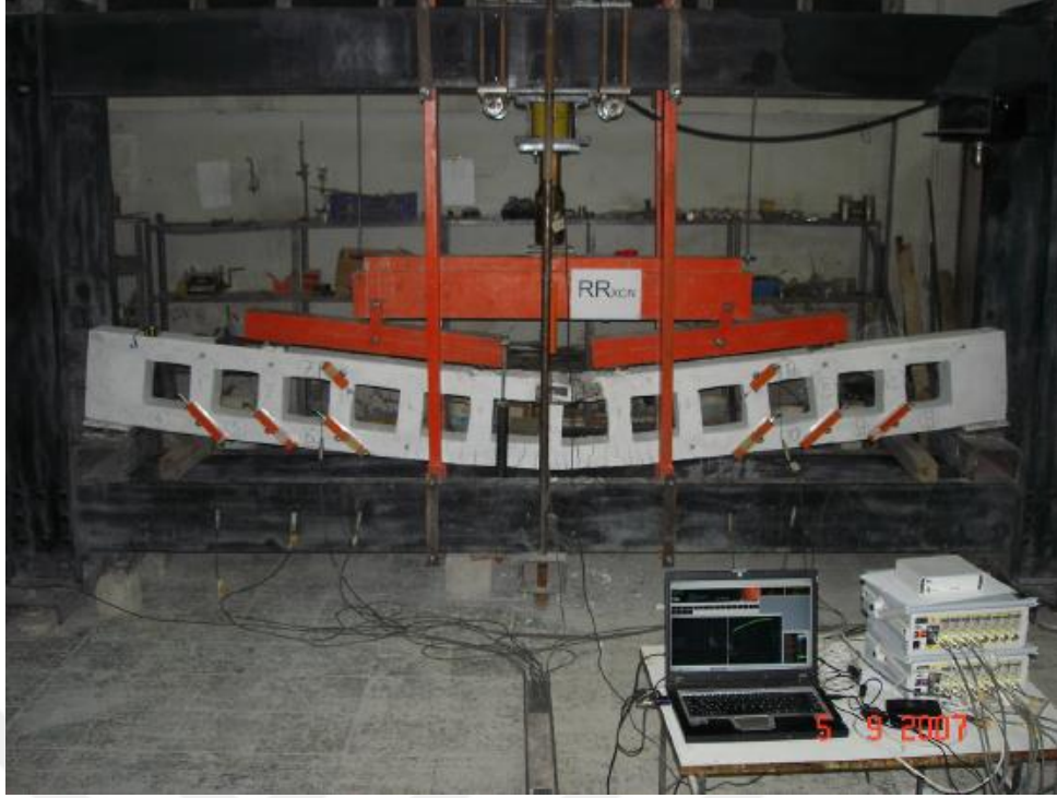
Şekil 3.16. RRxcn elemanın deneysel göçme modu [1]
