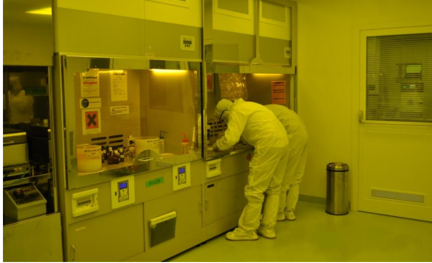
Şekil 2.9. Fotolitografi işlemlerinin yapıldığı sarı oda (UNAM)
