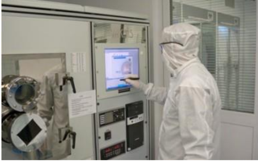
Şekil 2.7. Isısal buharlaştırma sistemi (UNAM-Vaksis PVD Vapor – 3S)
