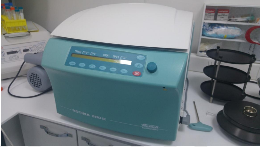
Şekil 2.5. Çalışmamızda kullandığımız Hettich marka Rotina 380 R model ultrasantrifüj.
