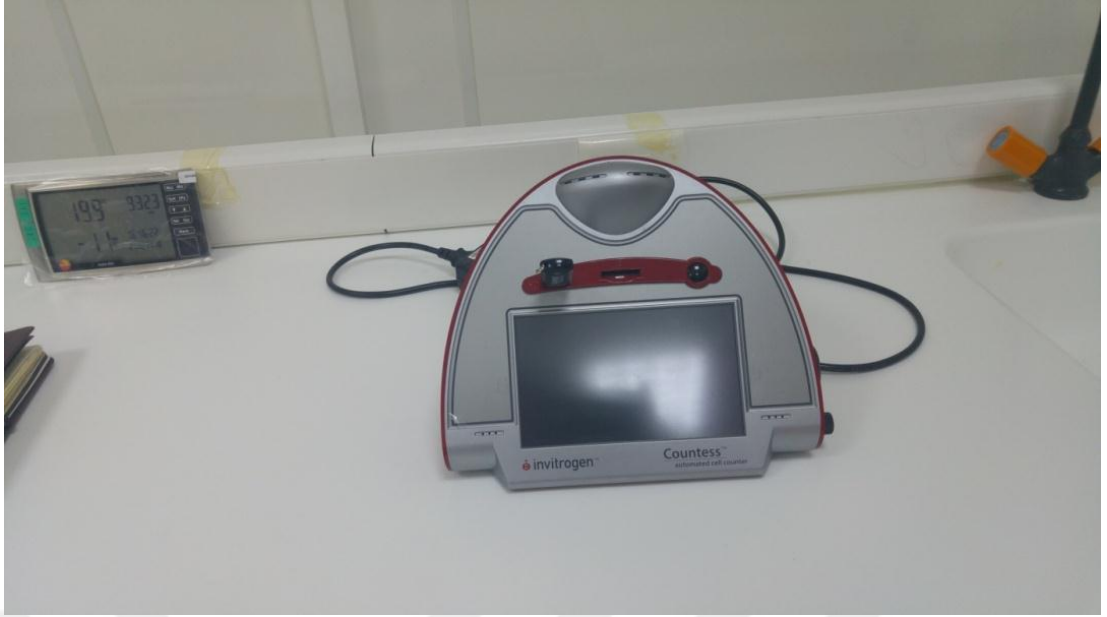
Şekil 2.3. Çalışmamızda kullandığımız İnvitrogen marka hücre sayım cihazı.
