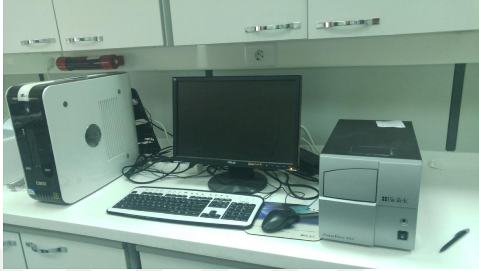
Şekil 2.1. Çalışmamızda kullandığımız BIOTEK marka Power Wave x52 model mikro plaka okuyuculu spektrofotometre.
