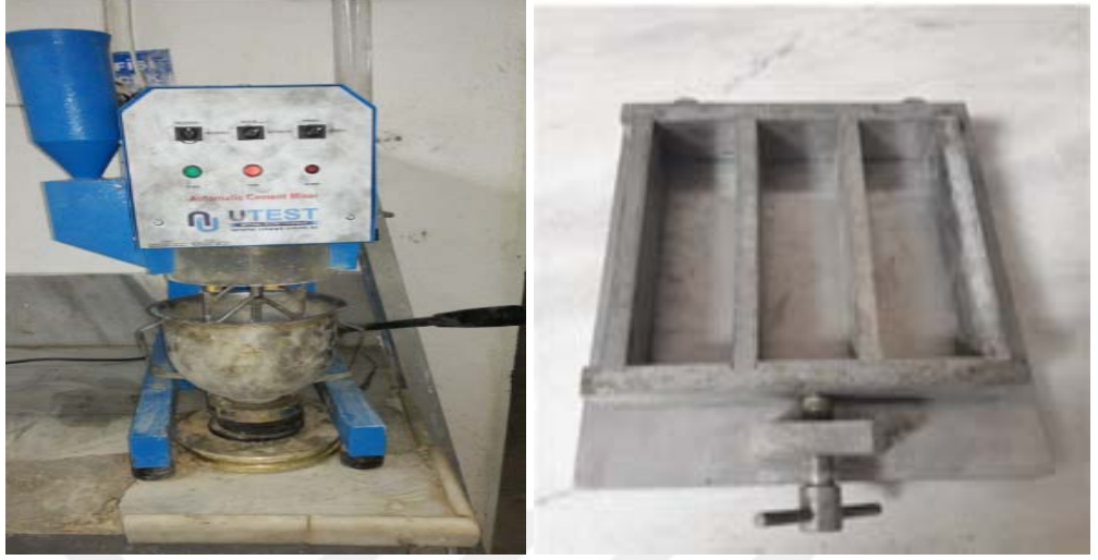
Şekil 3.7. a) TS EN 196-1’e otomatik mikser b) TS EN 196-1’e kalıp (40×40×160 mm)
