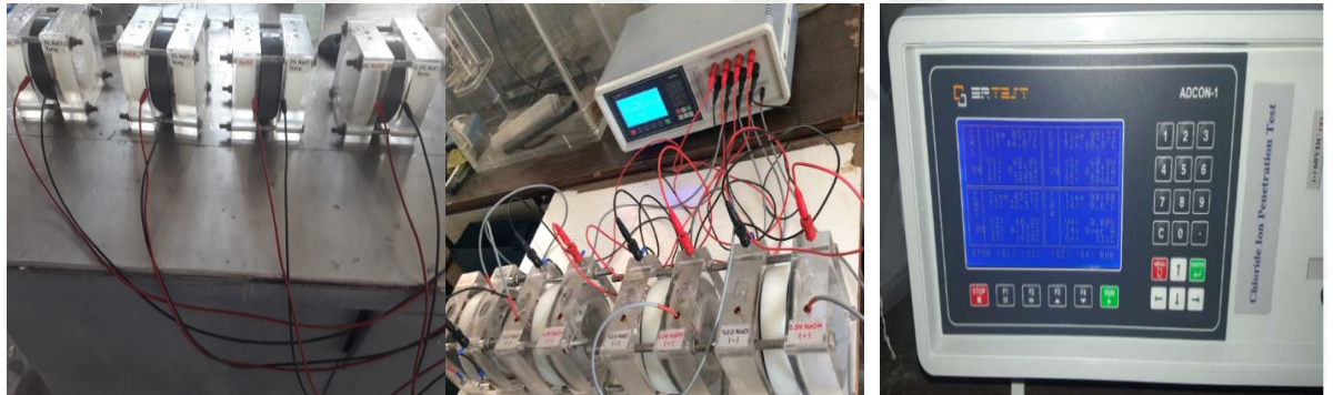
Şekil 3.13. Hızlı klorür iyonu geçirimsizliği deney hücrelerinin hazırlanması
