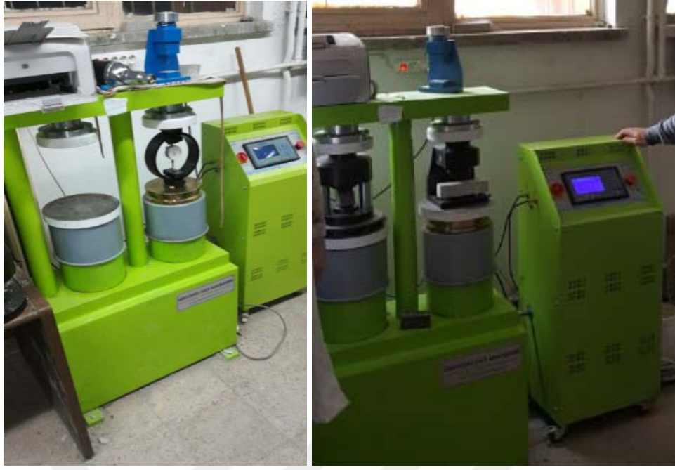
Şekil 3.10. TS 196-1'e uygun Çimento Presi
