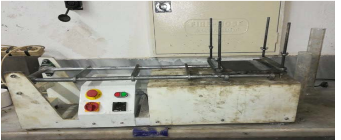
Şekil 3.8. TS EN 196-1’e uygun şok cihazı
