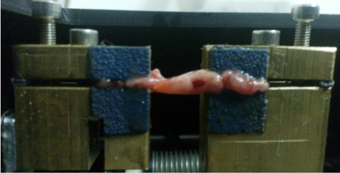
Resim 3.10. Transduser uçlarına yerleştirilmiş, gerim testi için hazır uterus
