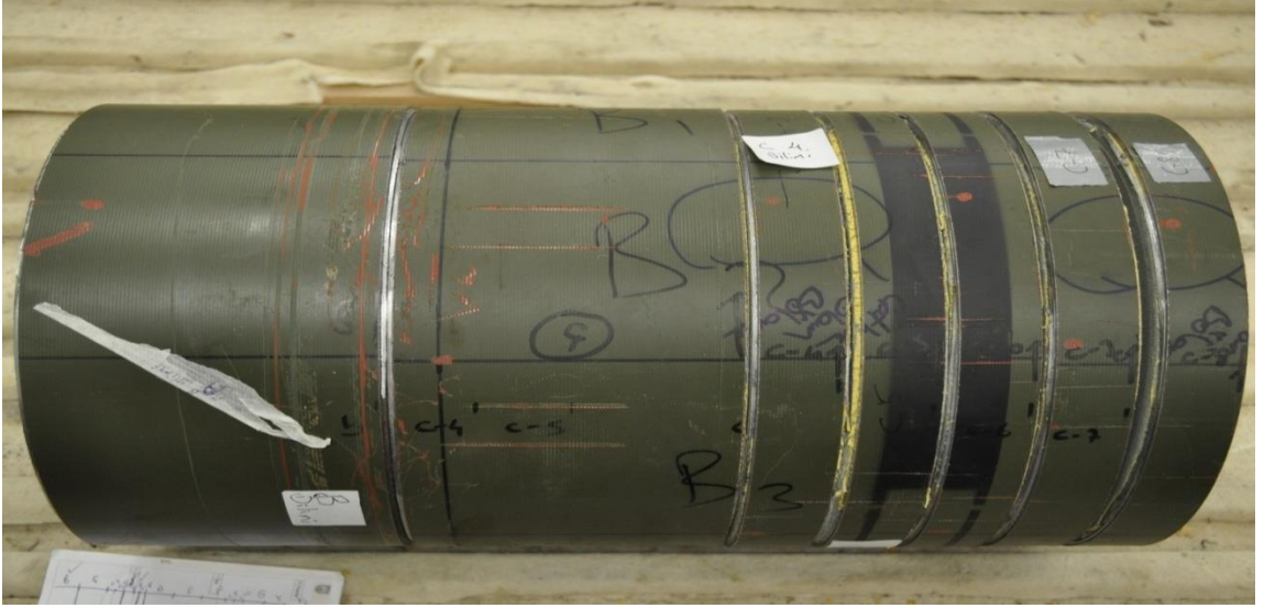
Şekil 3.1. Kompozit yakıtlı roket motoru parçası (50 cm)
