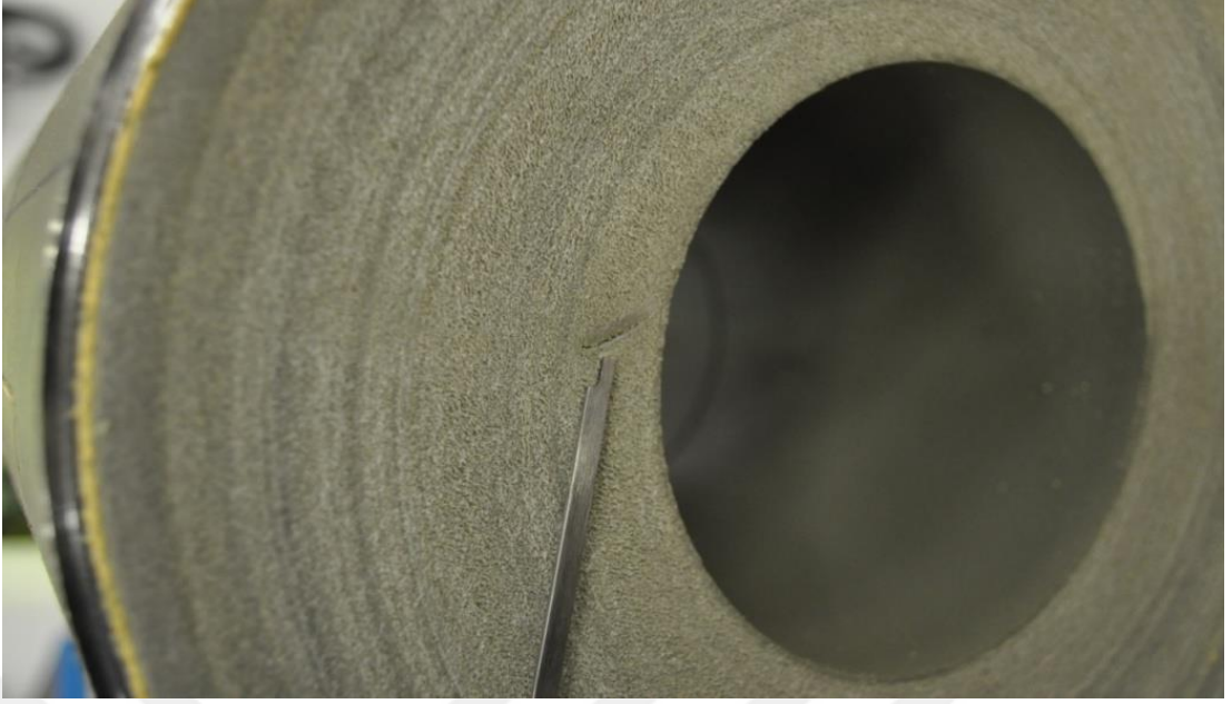
Şekil 2.18. Yakıt çekirdeği içerisinde oluşmuş bir çatlak
