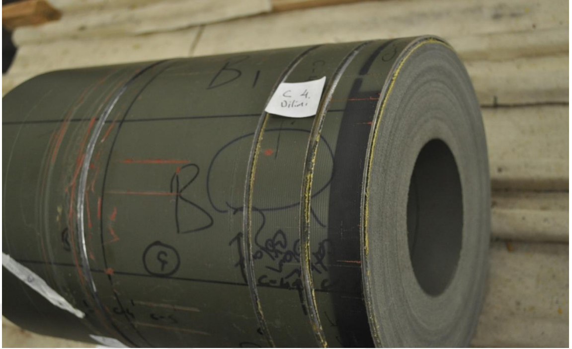
Şekil 3.4. Numune bölgeleri işaretlenmiş roket motor dilimleri
