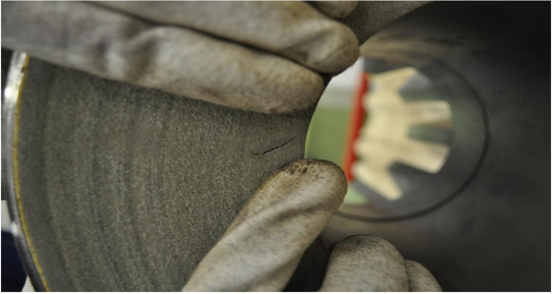
Şekil 2.19. Yakıt çekirdeği içerisinde oluşan çatlağın detaylı görünümü
