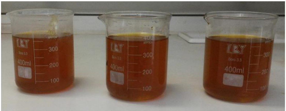
Şekil 4.29. \text{FeCl}_3 \cdot 6\text{H}_2\text{O} + \text{H}_2\text{O} bileşimi ile hazırlanmış çözeltinin test öncesi görünümü
