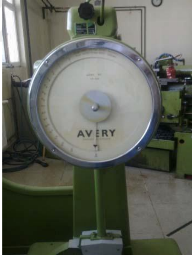
Şekil 4.23. Darbe test cihazı
