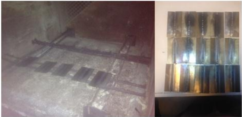
Şekil 4.9. Gerilim giderme işlemi sonrası kaynaklı numuneler
