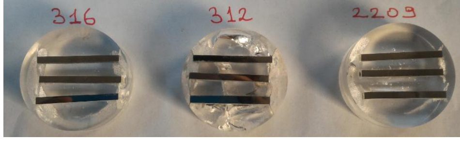
Şekil 4.17. Bakalit kalıba alınan mikro-yapı inceleme numuneleri
