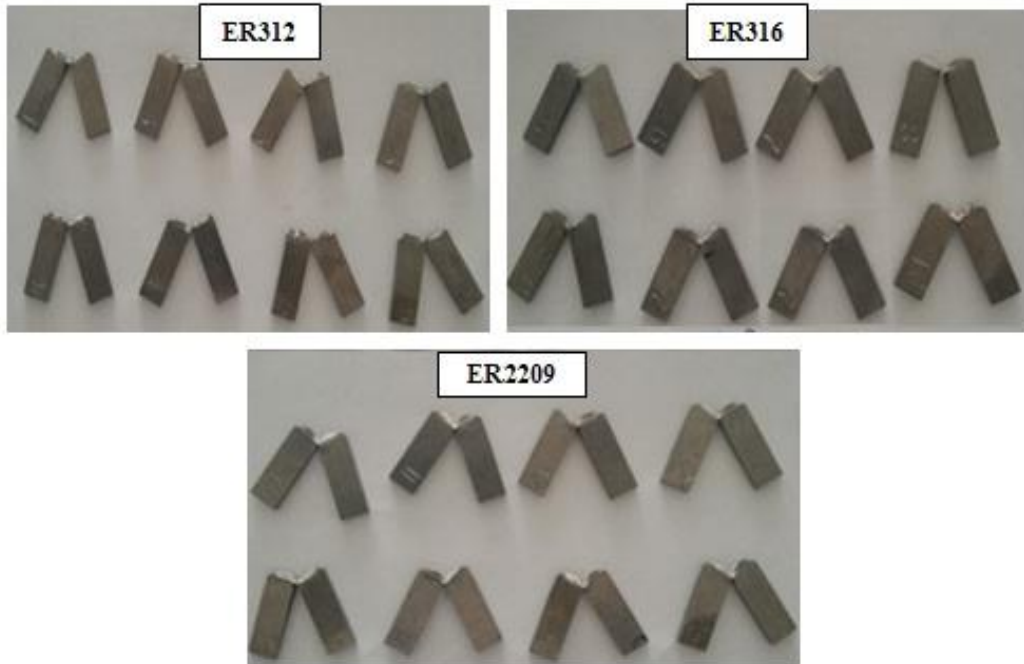
Şekil 4.25. Çentik darbe test numunelerin deney sonrası görüntüleri
