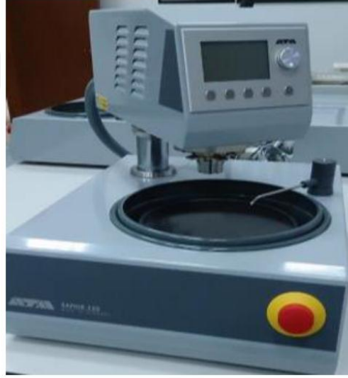
Şekil 4.18. Mikro-yapı çalışmalarında kullanılan parlatma cihazının görüntüsü
