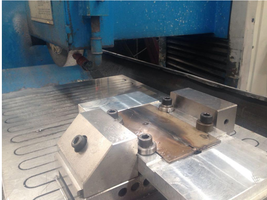
Şekil 4.12. Taşlama tezgâhı numune bağlama aparatı
