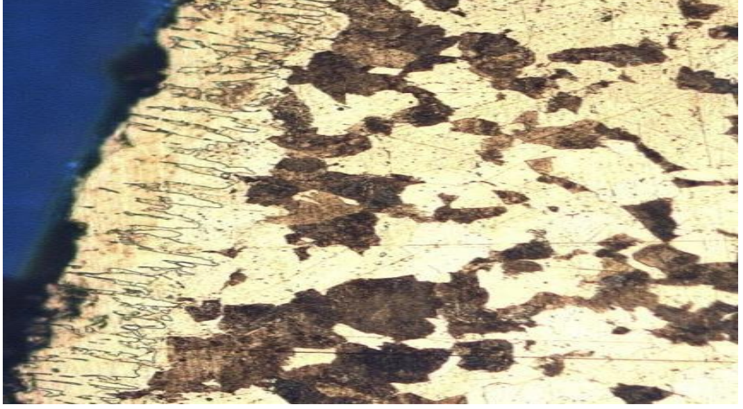
Şekil 6.15. 900 °C’de 6 saat borlanan numunenin 100x metalografik görüntüsü
