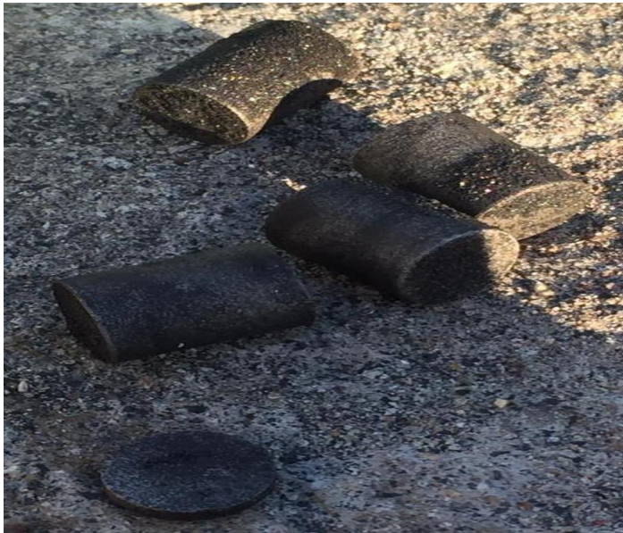
Şekil 6.1. Borlanan numunelerin potadan çıkarılmış görüntüleri
