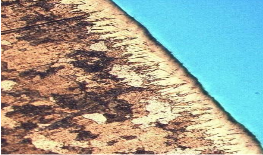
Şekil 6.11. 900 °C'de 2 saat borlanan numunenin 100x metalografik görüntüsü
