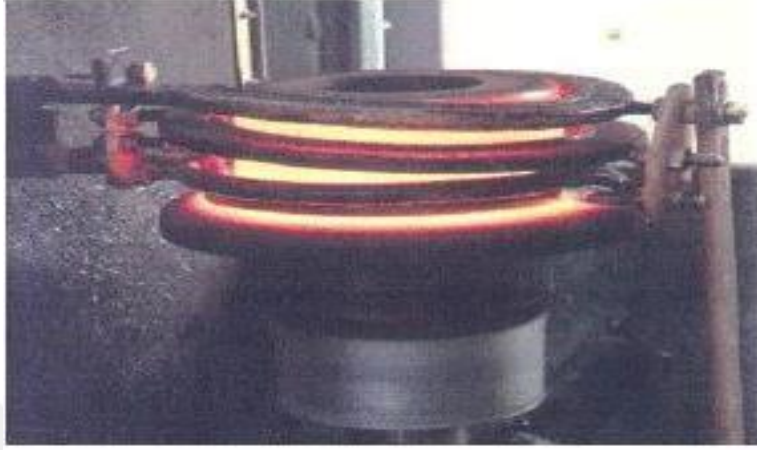
Şekil 2.2. Elektrik akımı frekansı ile endüksiyonla yüzey sertleştirme işlemi [21]
