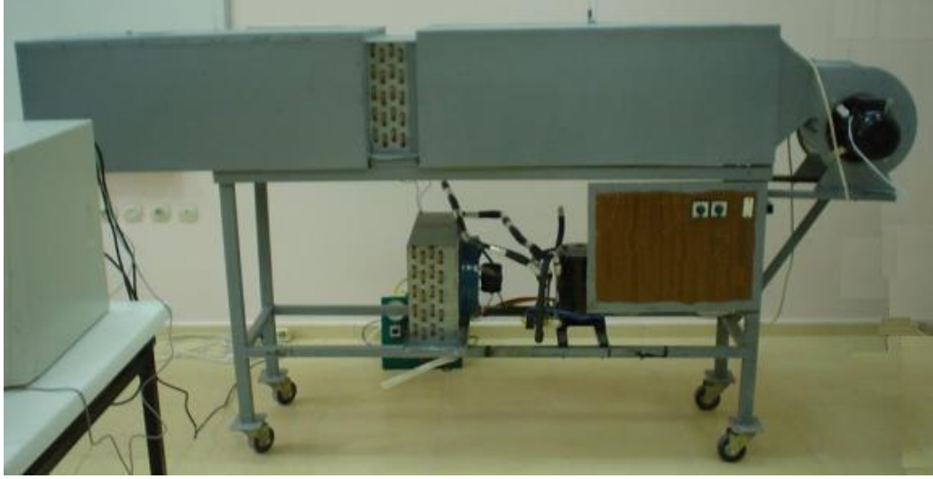
Şekil 2.7. Hava şartlandırma kanalı
