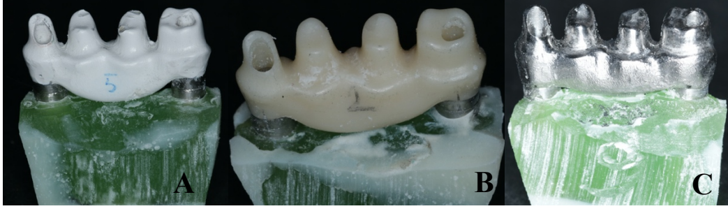
Şekil 2.13. Termomekanik yaşlandırma sonrası (A) PEEK, (B) Zirkonya, (C) Titanyum örnekler
