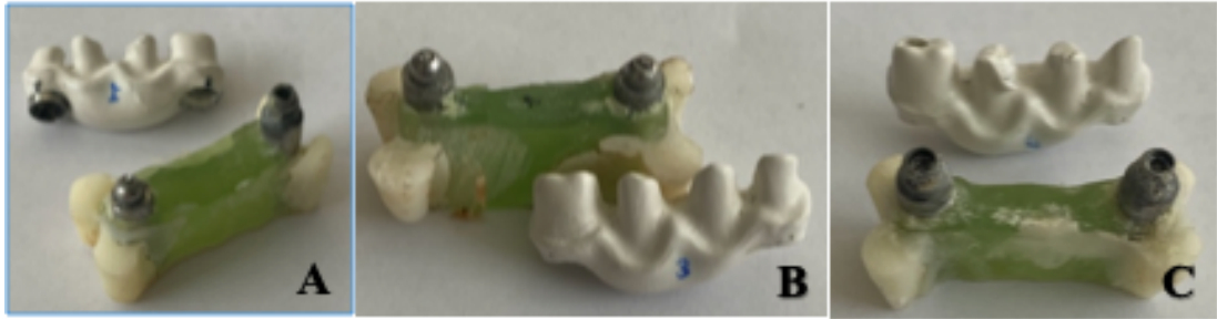
Şekil 3.11. (A) PEEK altyapıda görülen vida kırığı ile beraber görülen altyapıda deformasyon (Skor 6), (B)PEEK altyapıda görülen vida kırığı (Skor2), (C) PEEK altyapıda görülen desimantasyon beraber görülen altyapıda deformasyon (Skor5)
