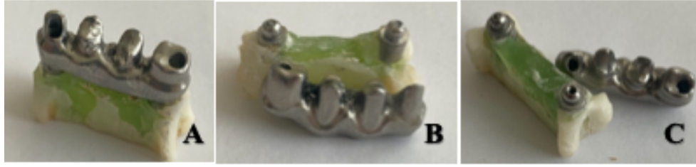
Şekil 3.15. (A)Titanyum örnekte görülen altyapı deformasyonu (Skor4), (B) ve (C) Titanyum örnekte görülen vida kırığı ile birlikte altyapı deformasyonu(Skor6)
