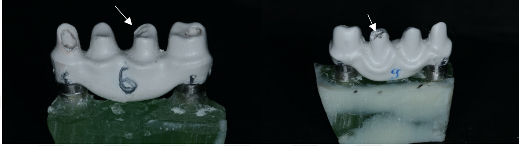
Şekil 3.1. Termomekanik yaşlandırma sonrası deformasyon görülen PEEK örnekler
