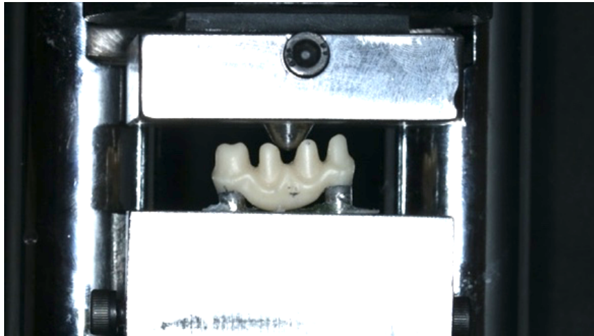
Şekil 2.21. Universal test cihazına yerleştirilen zirkonya örneğin fotoğrafı
