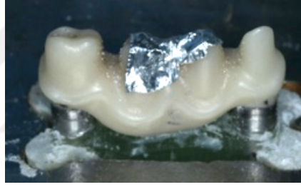
Şekil 2.20. Kırma testi sırasında kuvvetin homojen dağılması için örnekler ile kırma ucu arasında 0,5 mm kalınlığında alüminyum folyo kullanılmıştır.
