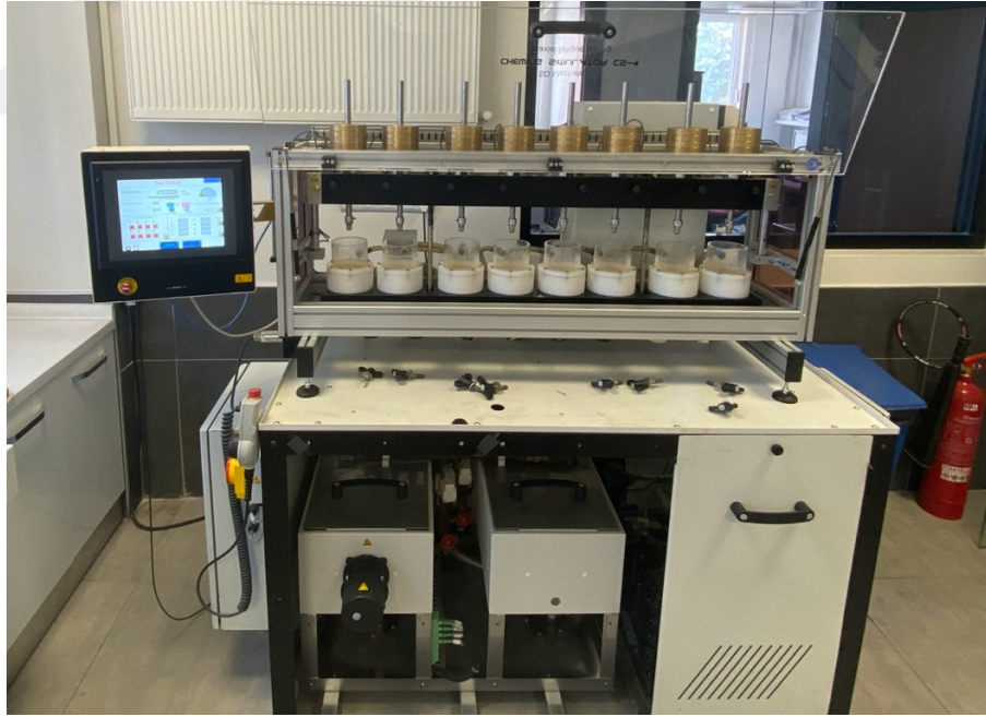
Şekil 2.12. Çiğneme simülatörü SD Mechatronik Chewing Simulator CS-4
