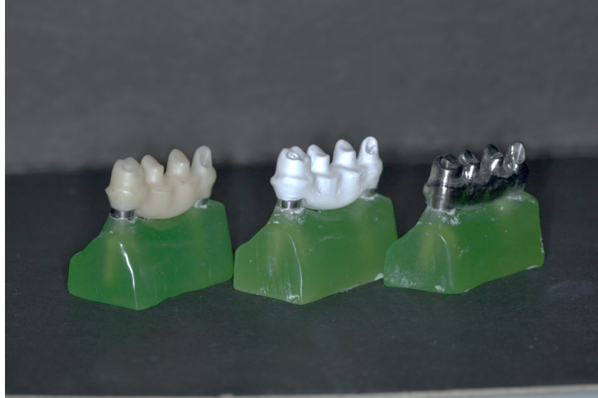
Şekil 2.11. Hazırlanmış örnekler (soldan sağa Zirkonya, PEEK ve Titanyum)
