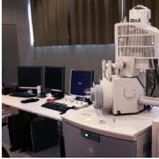
Şekil2.9. ODTÜ Merkez Lab. Taramalı Elektron Mikroskobu
