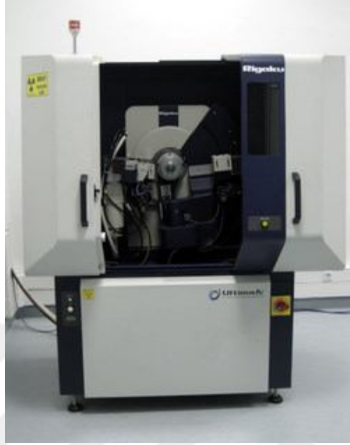
Şekil 2.8. ODTÜ Merkez Lab. X- Işını Difraktometresi
