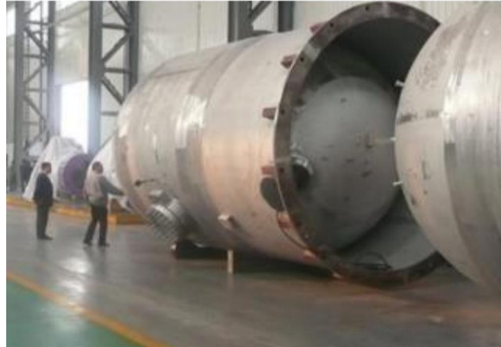
Şekil 1.12. Olkiluoto 3, Finlandiya Nükleer Santral Akümülatör Tankı (Backhouse, 2015, www.twi-global.com/EasySiteWeb/GatewayLink.aspx?alId=3792807 , Erişim tarihi: 17 Haziran 2018)
