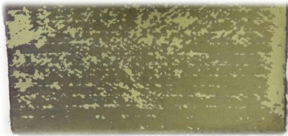
Şekil 6.9. TiB_2 İlaveli Kesime Hazır Numune
