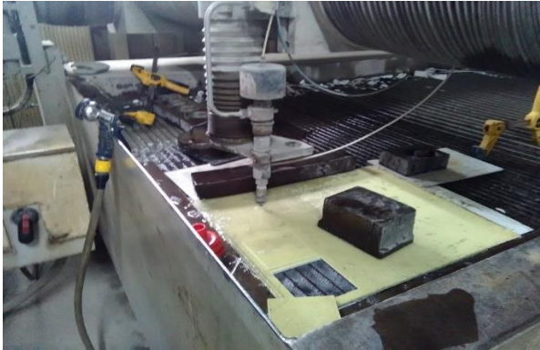
Şekil 6.11. Su Jetinde Numunelerin Kesimleri
