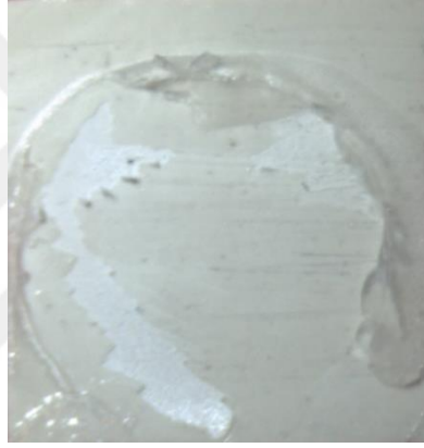
Şekil 3. 28 Asit + UV + Bond grubu karışık kırılma tipini gösteren stereomikroskop görüntüsü
