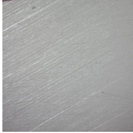
Şekil 3. 2 Kontrol grubu adeziv kırılma tipini gösteren stereomikroskop görüntüsü
