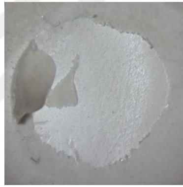
Şekil 3. 7 Asit + Bond grubu kırılma tiplerini gösteren stereomikroskop görüntüleri: (a) koheziv kırılma tipi, (b) karışık kırılma tipi
