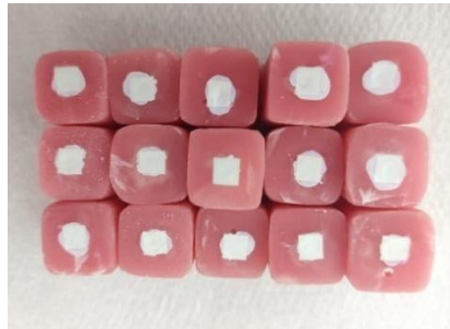
Şekil 2. 13 Kumlama + Asit: 110 \mu\text{m} \text{Al}_2\text{O}_3 ile Kumlama + %98 Sülfürik Asit Uygulaması
