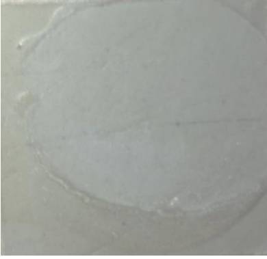
Şekil 3. 27 Asit + UV grubu kırılma tiplerini gösteren stereomikroskop görüntüleri: (a) adeziv kırılma tipi, (b) karışık kırılma tipi
