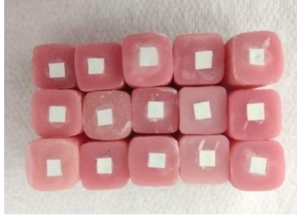
Şekil 2. 9 Kumlama: 110 \mu\text{m} \text{Al}_2\text{O}_3 ile Kumlama
