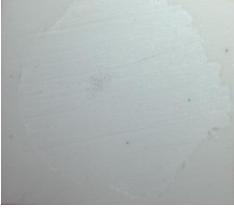
Şekil 3. 9 UV + Bond grubu kırılma tiplerini gösteren stereomikroskop görüntüleri: (a) adeziv kırılma tipi, (b) karışık kırılma tipi
