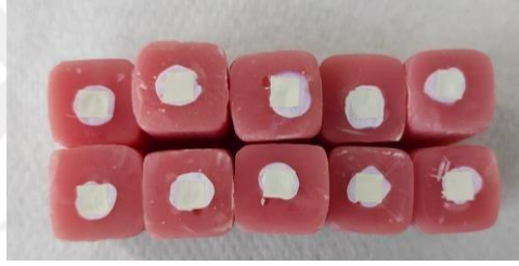
Şekil 2. 16 Kumlama + Asit + UV: 110 µm Al 2 O 3 ile Kumlama + %98 Sulfürik Asit + UV Işık Uygulaması
