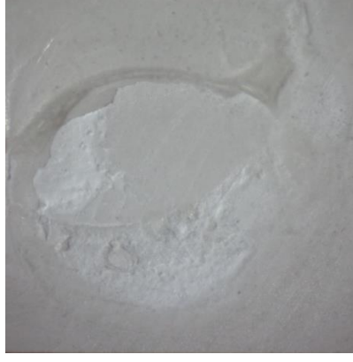
Şekil 3. 21 Asit grubu karışık kırılma tipini gösteren stereomikroskop görüntüsü
