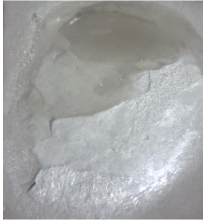
Şekil 3. 26 Kumlama + Asit + Bond grubu karışık kırılma tipini gösteren stereomikroskop görüntüsü
