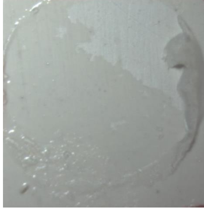
Şekil 3. 24 UV + Bond grubu karışık kırılma tipini gösteren stereomikroskop görüntüsü
