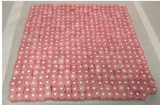
Şekil 2. 6 Yüzey işlemleri için hazırlanmış PEEK örnekler
