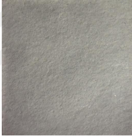
Şekil 3. 4 Kumlama grubu adeziv kırılma tipini gösteren stereomikroskop görüntüsü
