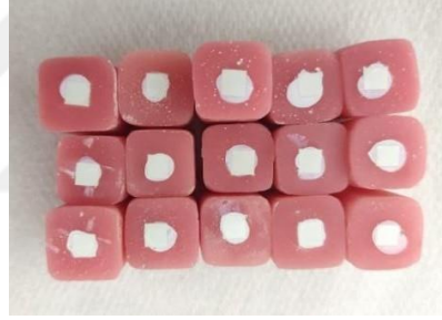
Şekil 2. 10 Asit: %98 Sülfürik Asit Uygulaması
