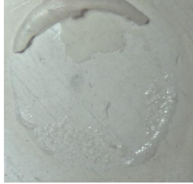
Şekil 3. 27 Asit + UV grubu kırılma tiplerini gösteren stereomikroskop görüntüleri: (a) adeziv kırılma tipi, (b) karışık kırılma tipi
