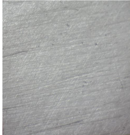
Şekil 3. 17 Kontrol grubu adeziv kırılma tipini gösteren stereomikroskop görüntüsü
