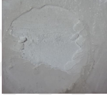
Şekil 3. 22 Asit + Bond grubu karışık kırılma tipini gösteren stereomikroskop görüntüsü
