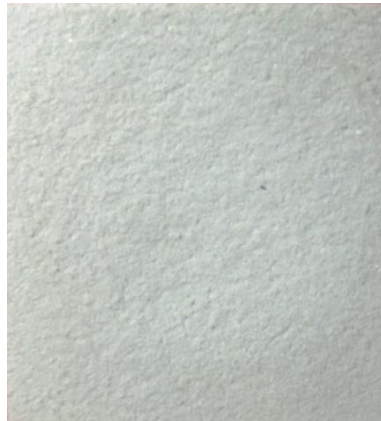
Şekil 3. 14 Kumlama + UV grubu adeziv kırılma tipini gösteren stereomikroskop görüntüsü
