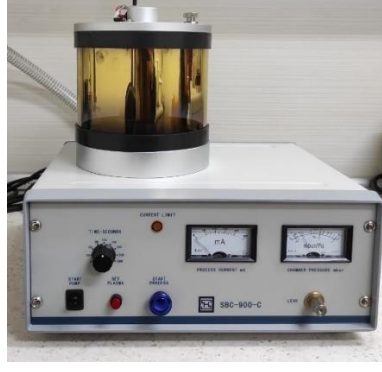
Şekil 2. 19 Yalıtkan madde kaplama cihazı
