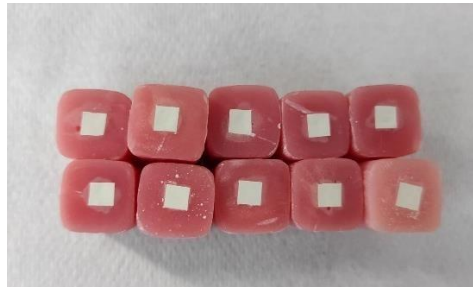
Şekil 2. 15 Kumlama + UV: 110 µm Al 2 O 3 ile Kumlama + UV Işık Uygulaması
