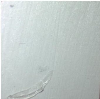
Şekil 3. 8 UV grubu kırılma tiplerini gösteren stereomikroskop görüntüleri: (a) karışık kırılma tipi, (b) adeziv kırılma tipi
