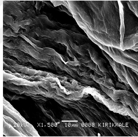
(h) NaAlg-aşı-PDEAAm kopolimerine ait SEM görüntüsü (x1500)
