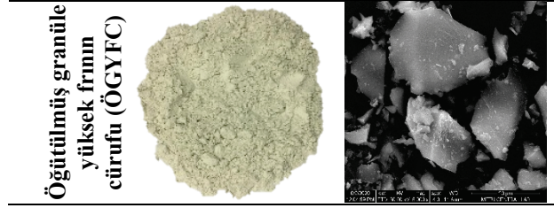
Şekil 3.7. Öğütülmüş granüle yüksek fırın cürufunun dijital kamera ve SEM görüntüleri (soldan sağa doğru sırasıyla; dijital kamera altında öğütülmüş ve SEM altında öğütülmüş görüntüsü)
