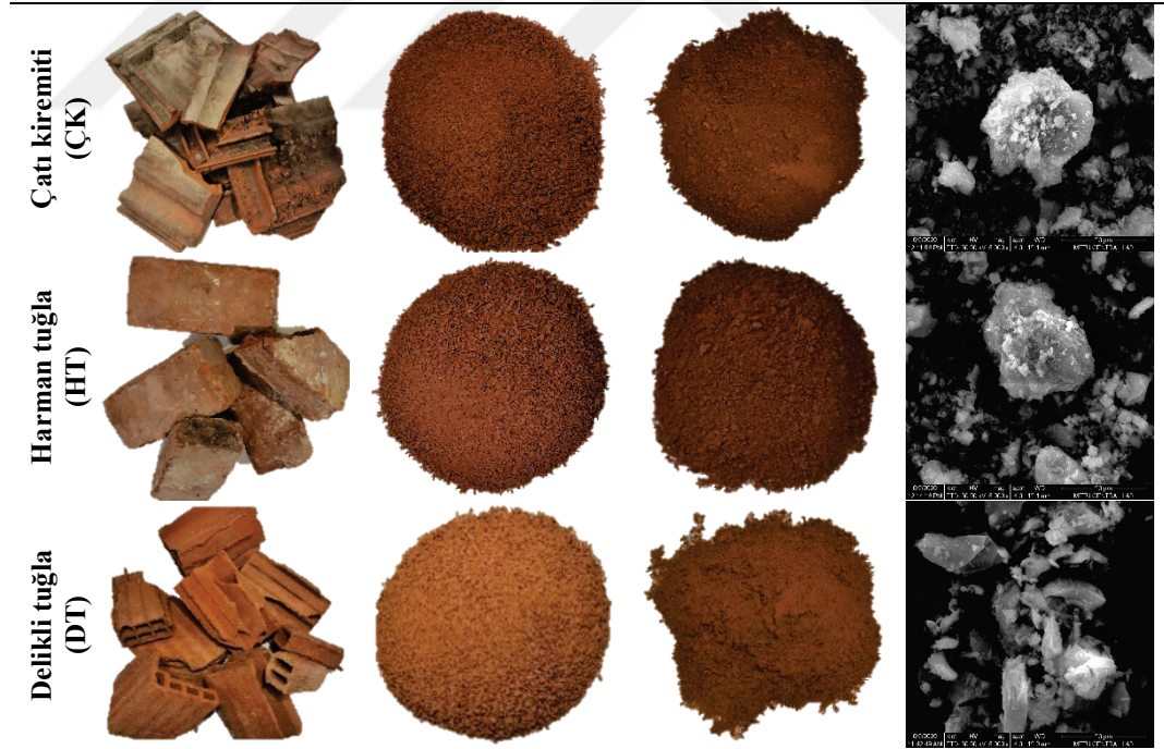
Şekil 3.4. Çatı kiremiti, harman tuğla ve delikli tuğlanın dijital kamera ve SEM görüntüleri (soldan sağa doğru sırasıyla; dijital kamera altında ham, kırılmış, öğütülmüş ve SEM altında öğütülmüş görüntüsü)
