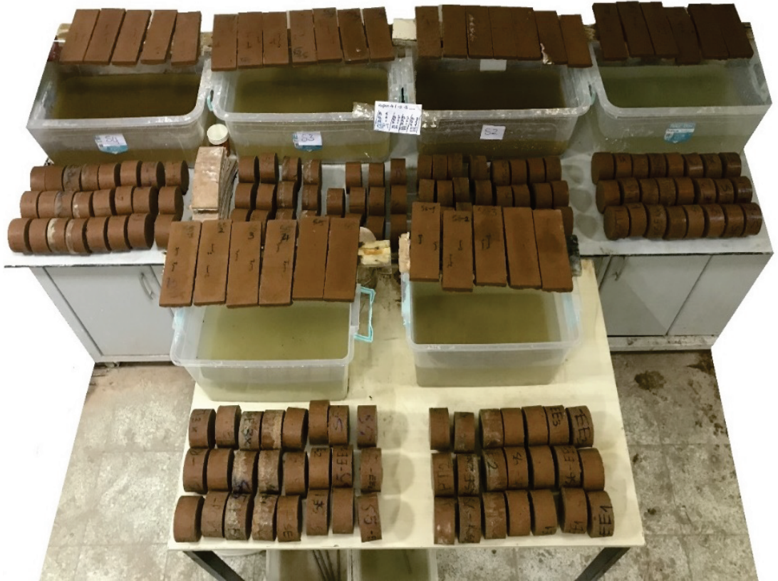
Şekil 3.26. EGC karışımlarının I-K döngüsüne maruz bırakılmaları
