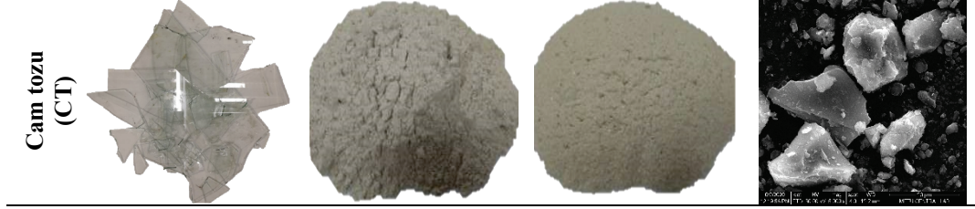
Şekil 3.5. Cam atığının dijital kamera ve SEM görüntüleri (soldan sağa doğru sırasıyla; dijital kamera altında ham, kırılmış, öğütülmüş ve SEM altında öğütülmüş görüntüsü)
