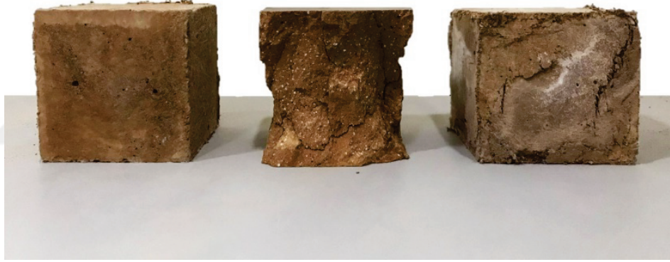
Şekil 5.2. Basınç dayanımı testinden önce ve sonra EGC numuneleri (soldan sağa lifli kırılmamış, lifsiz kırılmış, lifli kırılmış)
