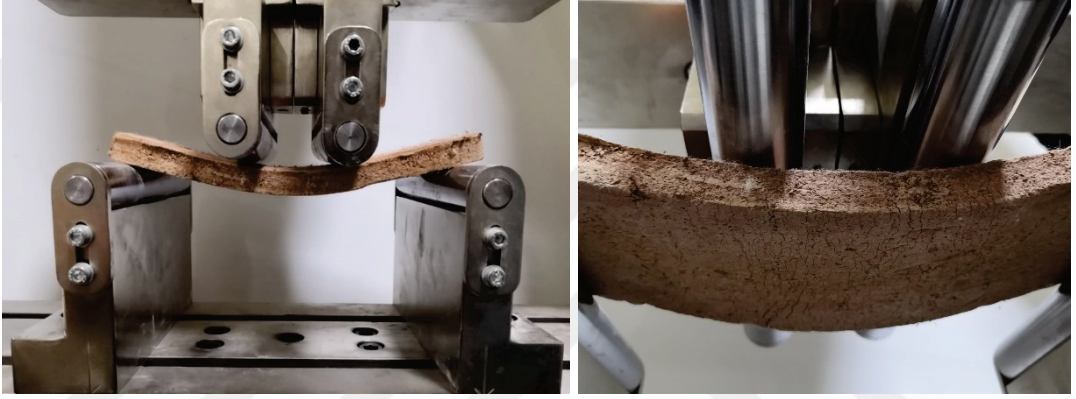
Şekil 4.13. PE lif takviyeli kompozitin eğilme yükleri altındaki davranışı ve çoklu mikro çatlakların oluşumu
