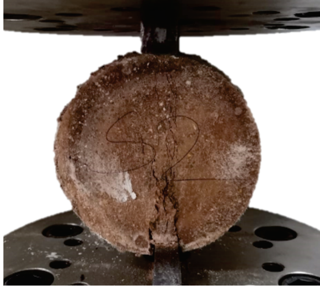
Şekil 5.7. Yarmada çekme yüklemesi altında S2 kodlu EGC numunenin tipik davranışı
