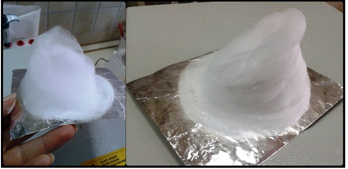
Şekil 2.2. %40 METAK polimeri içeren çözeltiden elde edilen nanolif
