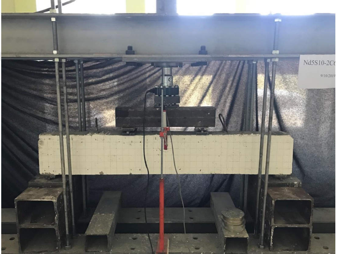
Şekil 2.18. Nd5S10-2C6 Kiriş Deney Başlangıcı
