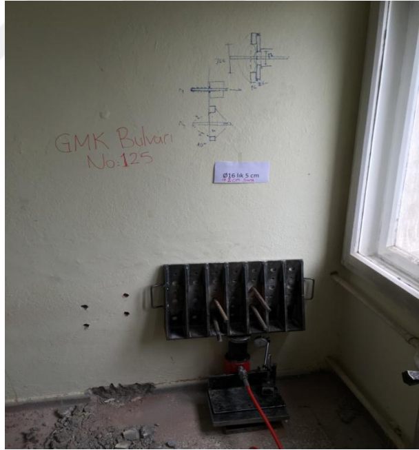
Şekil 2.22. Kesme Kuvveti İçin Ø16'lık Ankrajla Hazırlanan Deney Düzeneği
