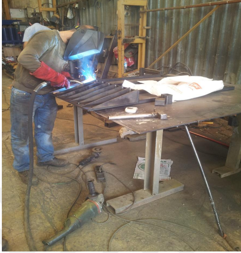
Şekil 2.13. Kesme Levhasının Kaynakla Birleşiminin Yapılması
