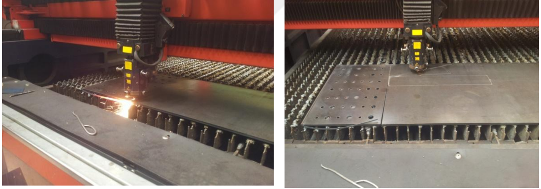
Şekil 2.12. Kesme Levhasının Projesine Göre CNC Tezgahında Kesim Aşamaları
