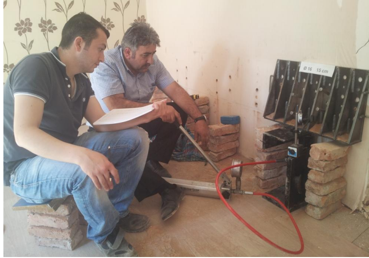
Şekil 3.7. Ø16'lık Ankraj Donatısıyla Oluşturulan Deney Düzeneği
