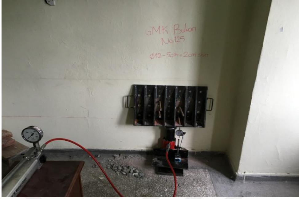
Şekil 2.21. Kesme Kuvveti İçin Ø12'lik Ankrajla Hazırlanan Deney Düzeneği
