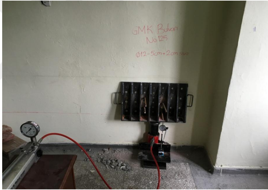
Şekil 3.5. Ø12'lik Ankrajla Oluşturulan Kesme Deney Düzeneği
