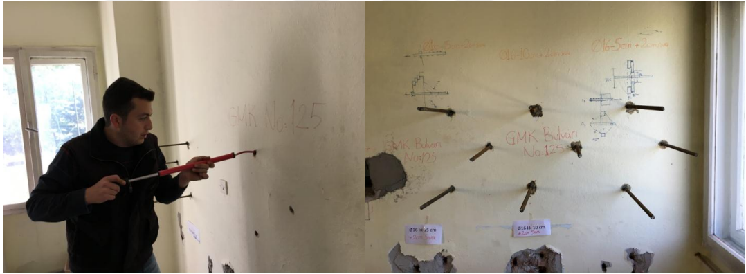
Şekil 2.23. B Grubu Deney Düzeneği Hazırlanırken Temizlik ve Ankraj Ekimi
