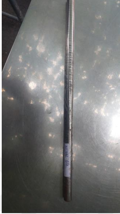
Şekil.6.2. 16 mm çapında ve 400 mm uzunluğunda Inconel 601 süper alaşımından imal edilmiş içi dolu çubuk numune.
