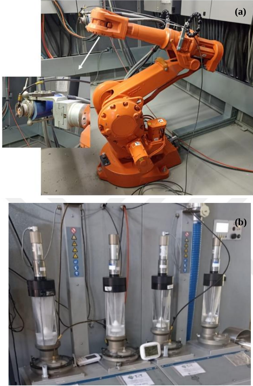
Şekil.6.7. Sulzer Metco termal sprey sistemi (a) püskürtme tabancası, 6 eksenli IRB2400 robot kolu ve genleşme nozulu (b) toz besleme ünitesi.
