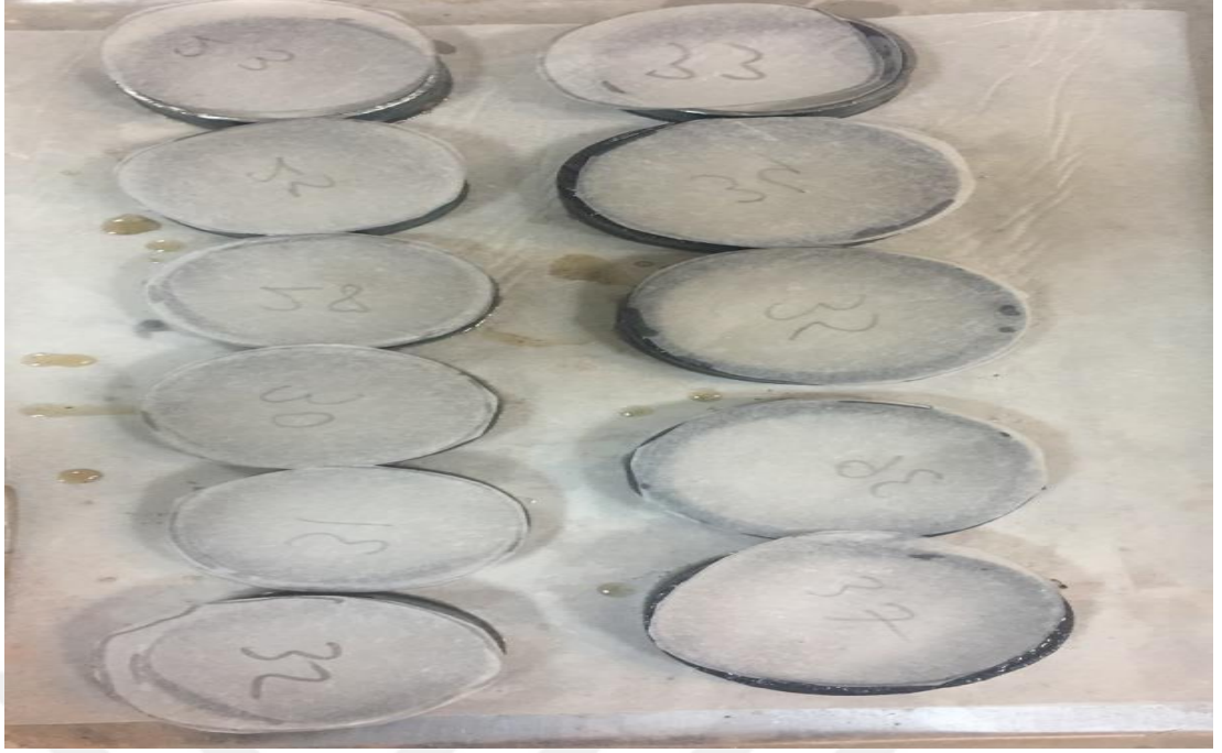
Şekil 2.11. ısı iletkenlik ölçümü yapılacak geopolimer örneklerin kalıpları
