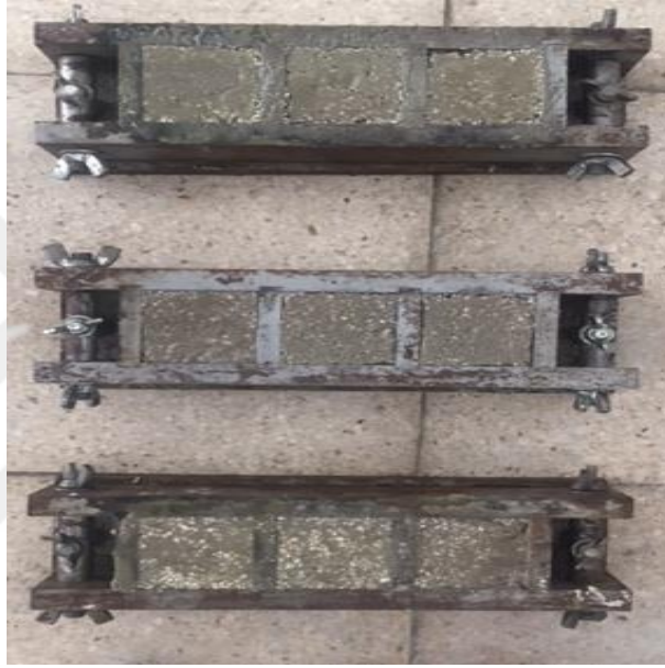
Şekil 2.7. Genleştirilmiş perlit agregalı geopolimer örneklerin kalıp içindeki görüntüsü
