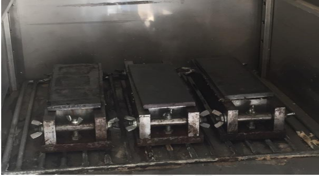
Şekil 2.6. Etüv içerisindeki geopolimer örnekler
