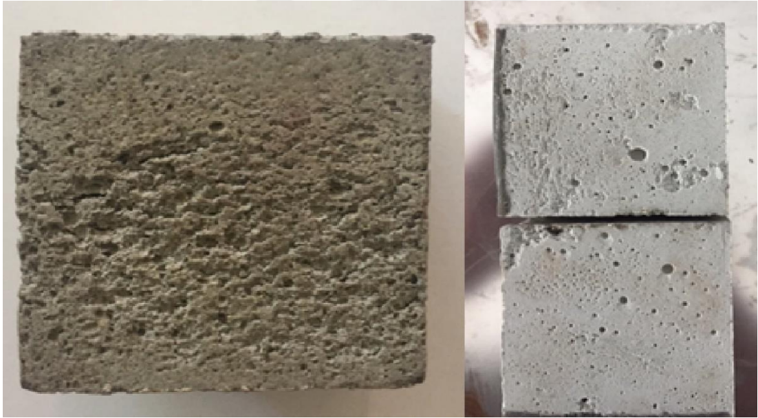
Şekil 2.9. Etüvden çıkarılmış 50x50x50 mm boyutlu geopolimer örneklerin görüntüsü
