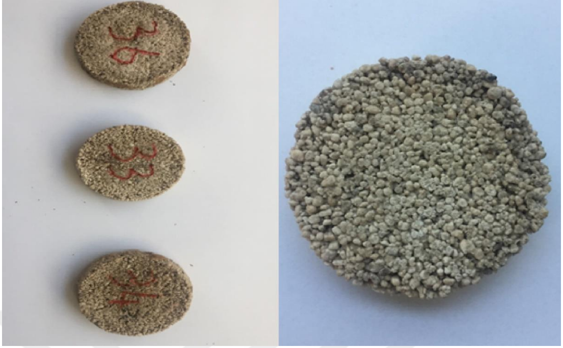
Şekil 2.12. Isıl iletkenlik ölçümü yapılacak örneklerin kalıptan çıkmış görüntüsü
