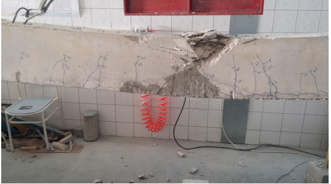
Şekil EK-4.16. G2S3 elemanı eğilme testi sonrası
