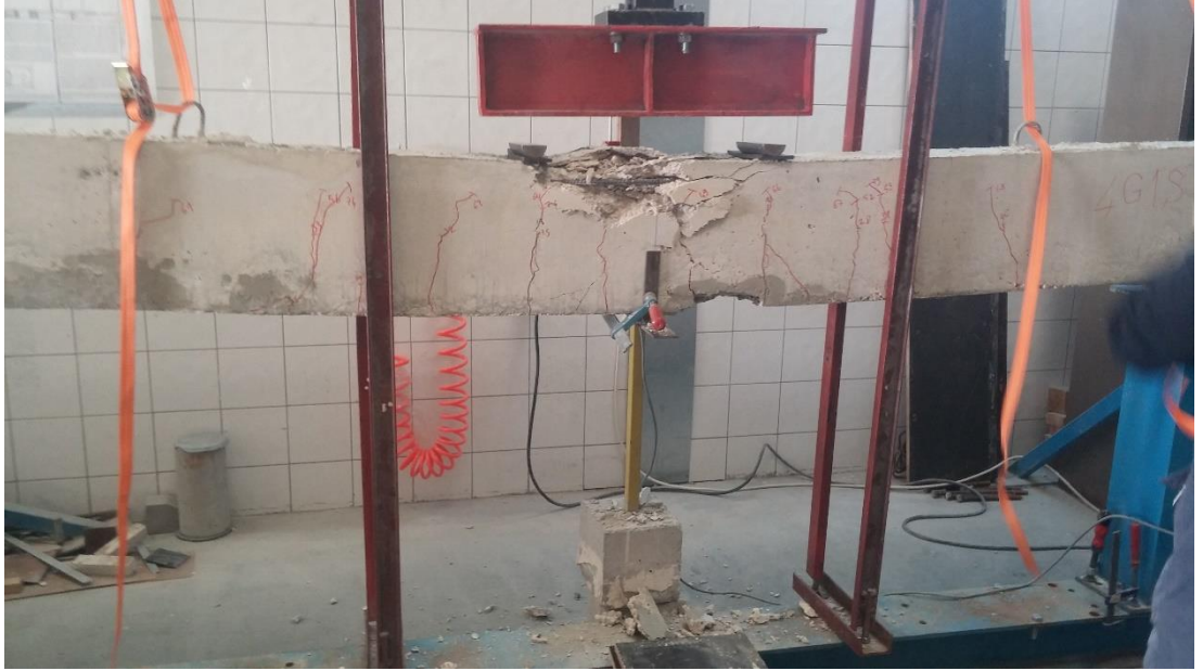
Şekil EK-4.20. G4S1 elemanı eğilme testi sonrası
