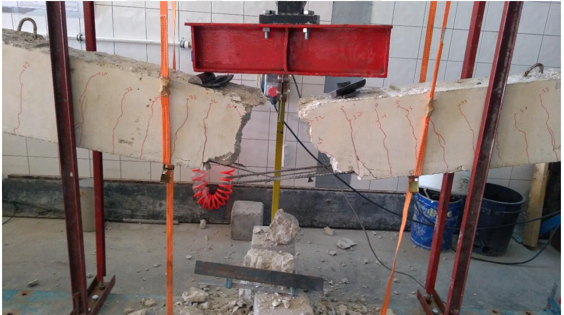
Şekil EK-4.44. B5 (B3) Referans elemanı eğilme testi sonrası
