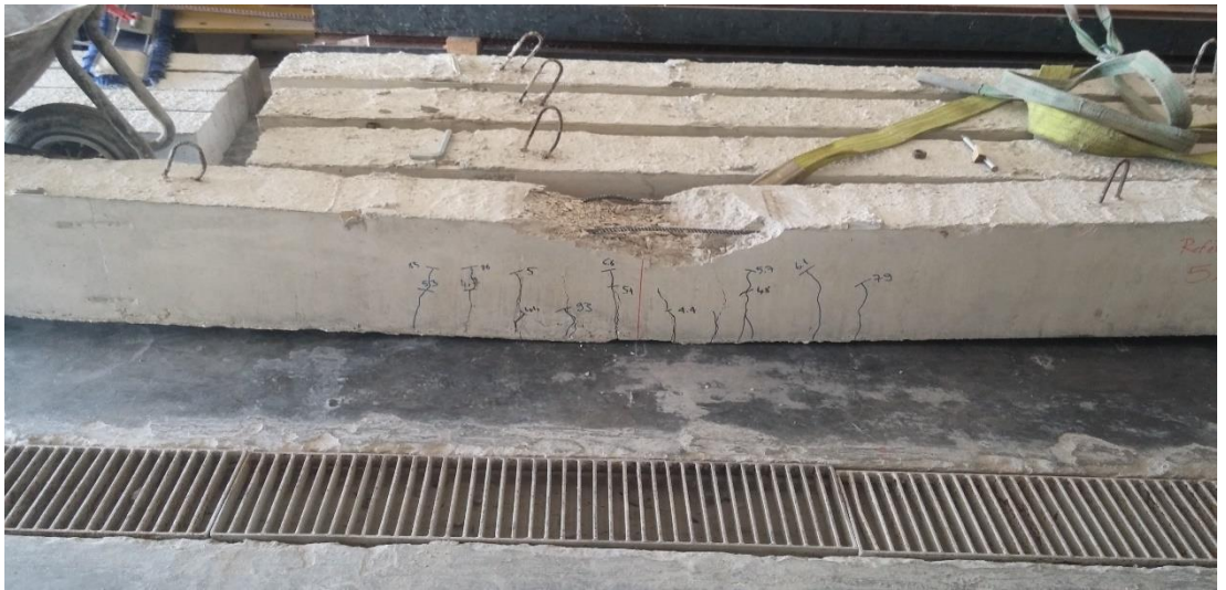
Şekil EK-4.2. Salt çelik donatılı S5 Referans elemanı eğilme testi sonrası
