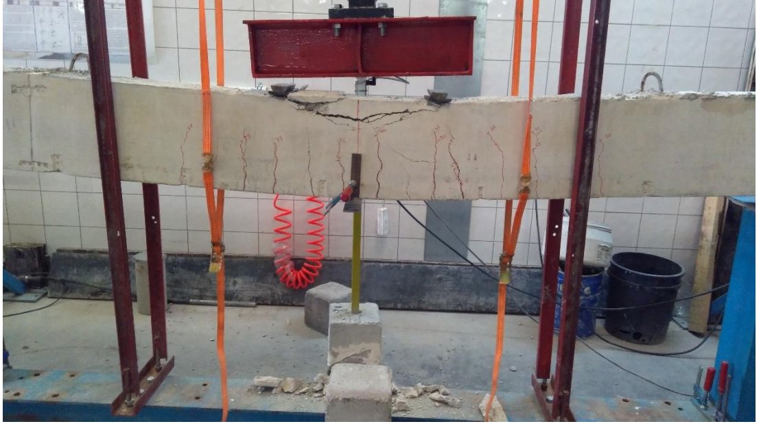
Şekil EK-4.40. B1S2 elemanı eğilme testi sonrası
