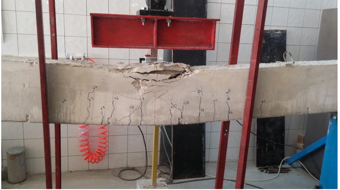
Şekil EK-4.4. B1S4 elemanı eğilme testi sonrası
