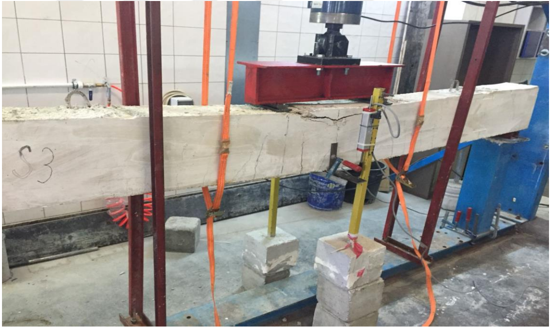
Şekil EK-4.38. Salt çelik donatılı S3 Referans elemanı eğilme testi sonrası
