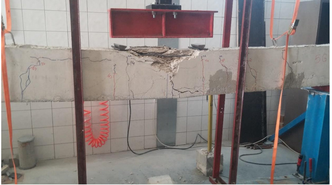
Şekil EK-4.22. G5 Referans elemanı eğilme testi sonrası
