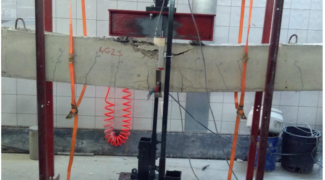
Şekil EK-4.32. G4S2 elemanı eğilme testi sonrası
