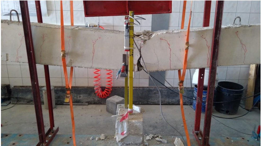
Şekil EK-4.50. G3 Referans elemanı eğilme testi sonrası
