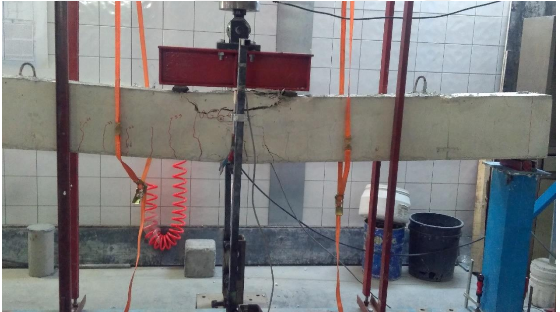
Şekil EK-4.24. Salt çelik donatılı S6 Referans elemanı eğilme testi sonrası
