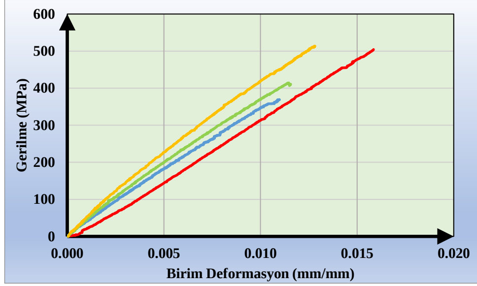
Şekil 3.5. GFRP Tip-1 donatıların çekme testlerine ait gerilme-birim deformasyon eğrileri
