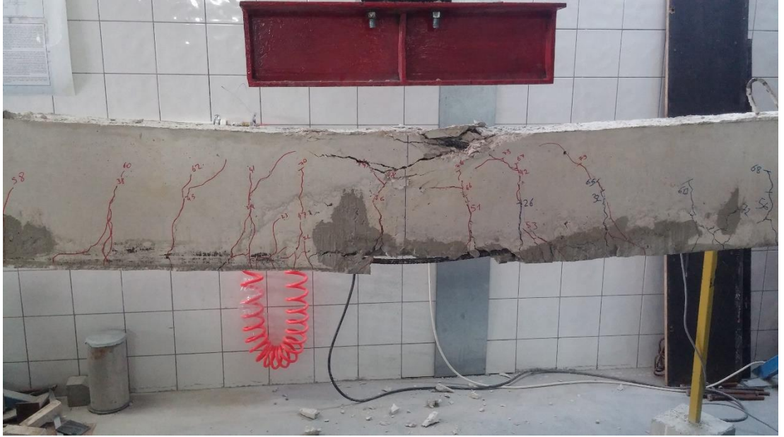
Şekil EK-4.18. G3S2 elemanı eğilme testi sonrası
