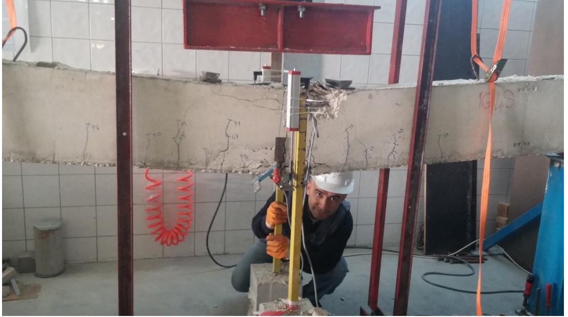
Şekil EK-4.14. G1S4 elemanı eğilme testi sonrası
