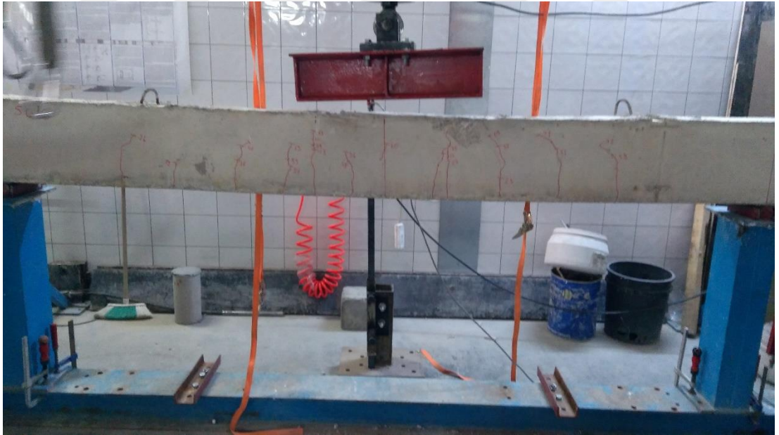
Şekil EK-4.34. G5S1 elemanı eğilme testi sonrası
