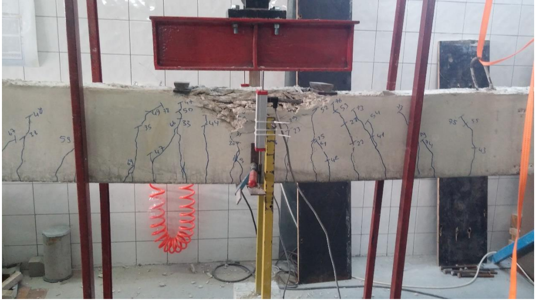
Şekil EK-4.10. B4S1 elemanı eğilme testi sonrası
