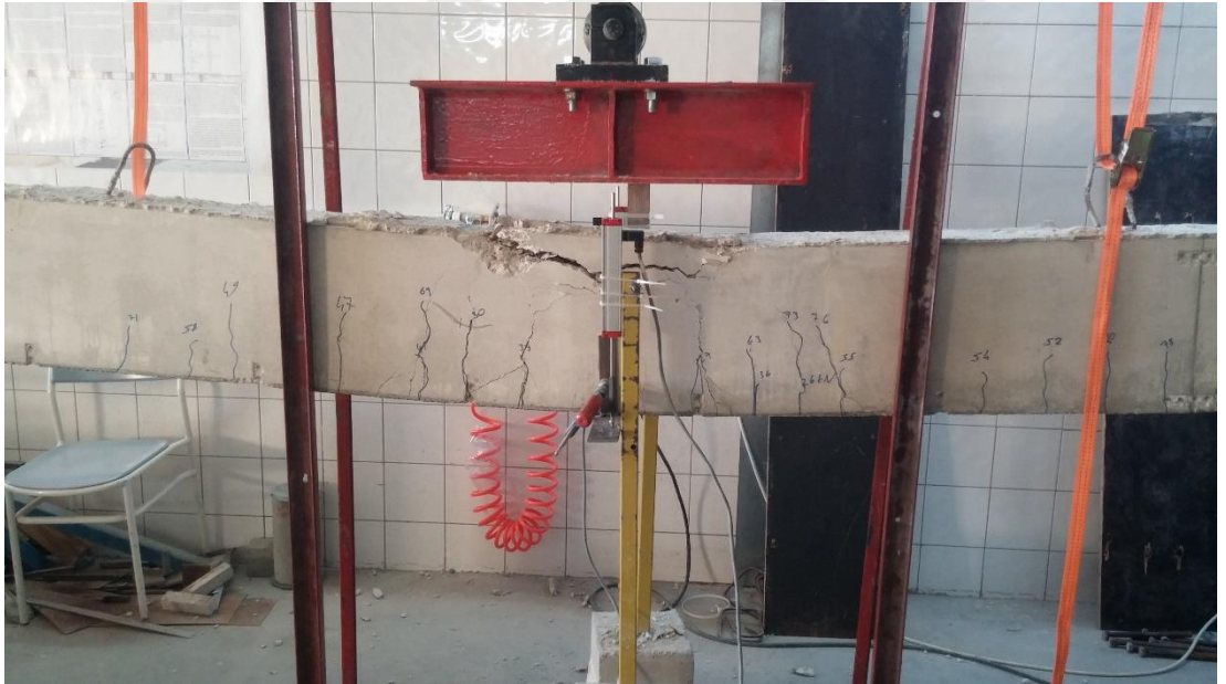
Şekil EK-4.6. B2S3 elemanı eğilme testi sonrası
