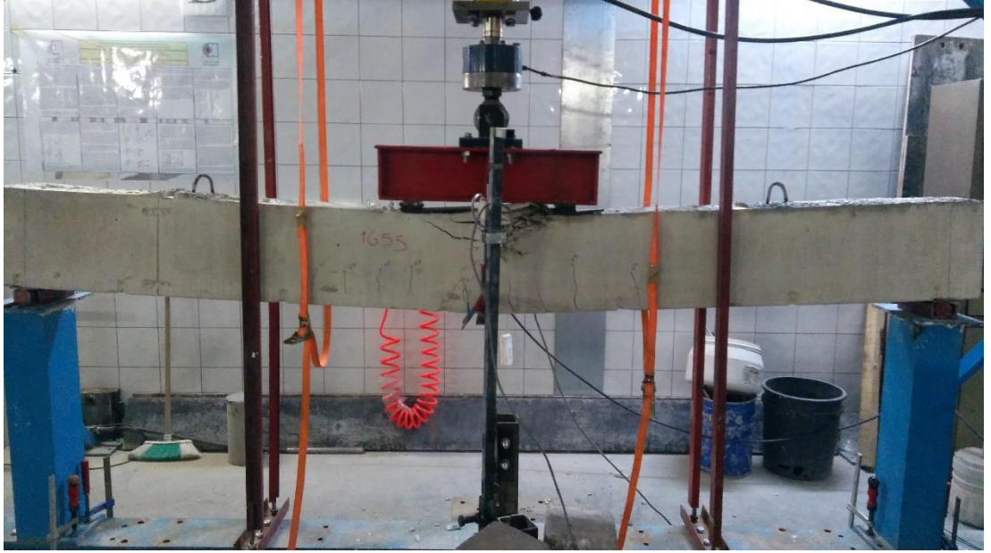
Şekil EK-4.26. G1S5 elemanı eğilme testi sonrası
