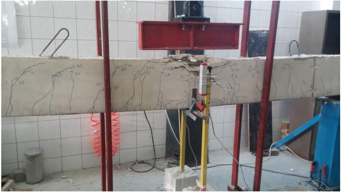
Şekil EK-4.12. B5 Referans elemanı eğilme testi sonrası
