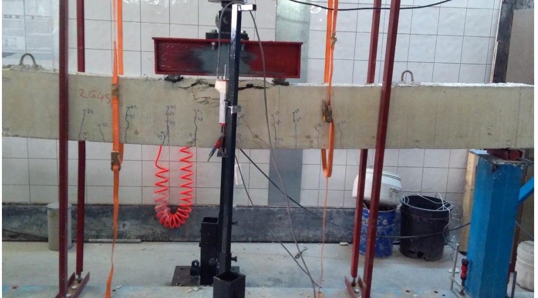
Şekil EK-4.28. G2S4 elemanı eğilme testi sonrası
