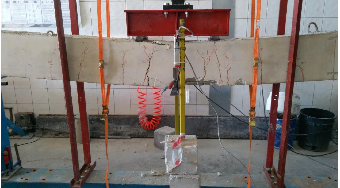
Şekil EK-4.48. G2S1 elemanı eğilme testi sonrası
