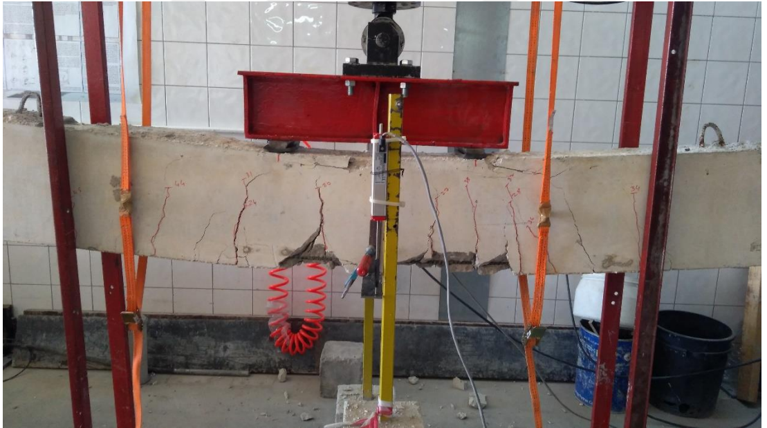
Şekil EK-4.42. B2S1 elemanı eğilme testi sonrası
