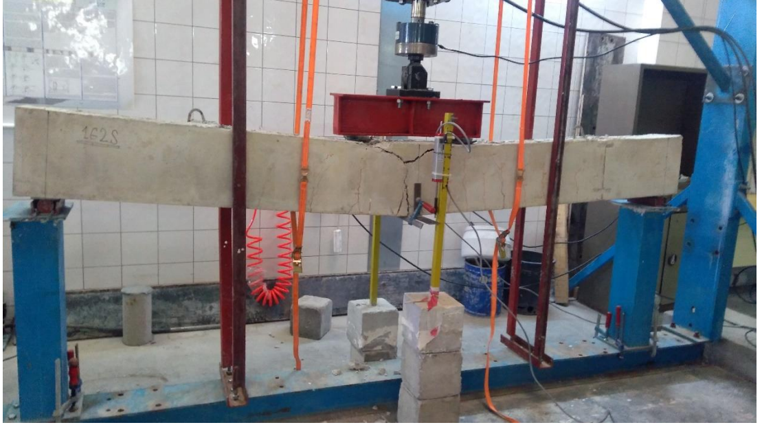
Şekil EK-4.46. G1S2 elemanı eğilme testi sonrası
