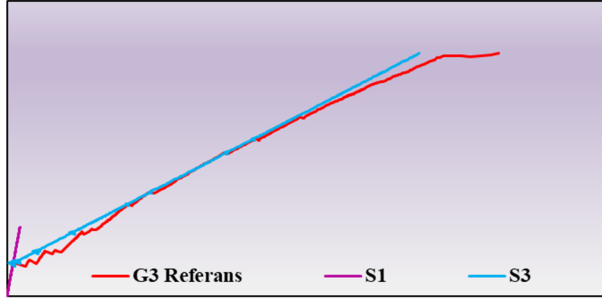
Şekil 6.47. G3 Referans kirişi yük-sehim eğrisi üzerinde doğrusal bölgelerin gösterimi
