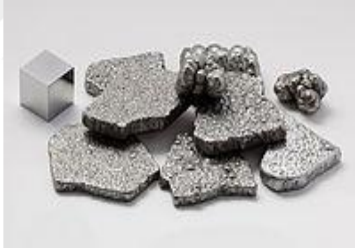
Şekil 3.32. Elektrolizle arıtılmış (%99,97+) saflıkta demir parçaları ve karşılaştırma için yüksek saflıkta (99,9999 % = 6N) 1 cm 3 hacminde demirden bir küp
