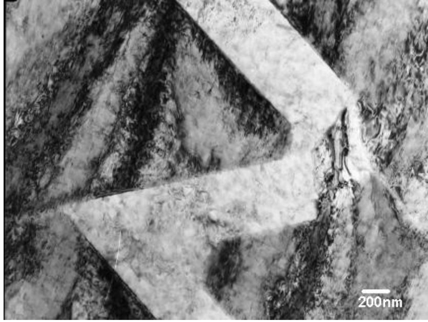
Şekil 3.20.a. Fe-%30Ni-%2.6Mo alaşımda austenite ve martensite faza ait aydınlık alan görüntüsü.
