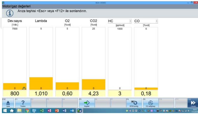
Şekil 3.3. Emisyon ölçüm cihazı ve yazılım ara yüzü
