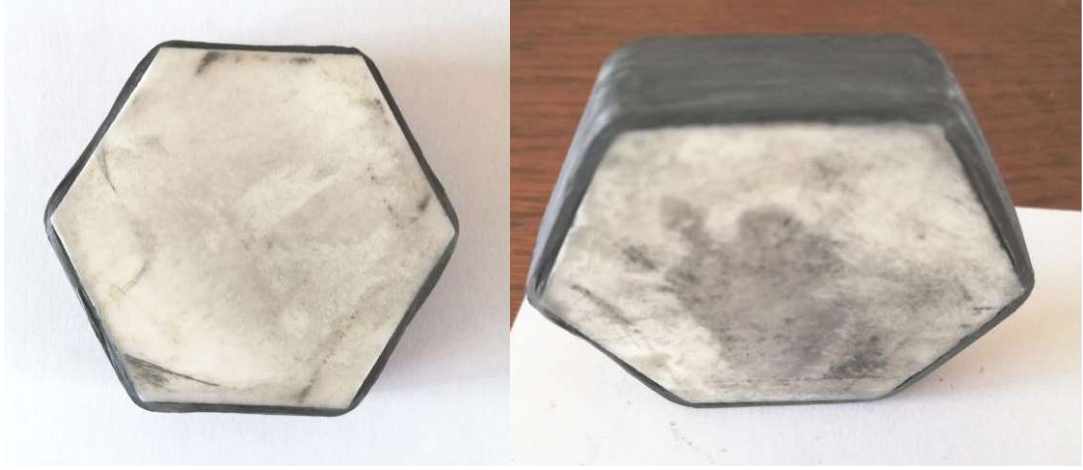
Şekil 3.8. Flaman sarım metoduyla hazırlanan çevresi kompozit sargılı alümina seramik
