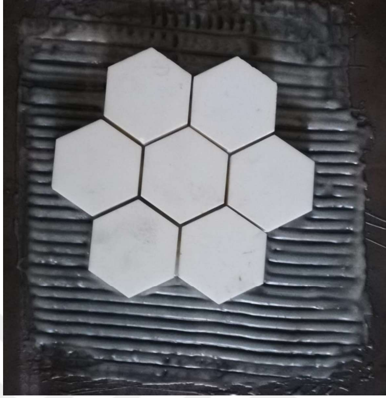
Şekil 3.4. Çevresi kompozit sargısız arası boşluklu ve hardox çelik saca yapıştırılmış deney numunesi
