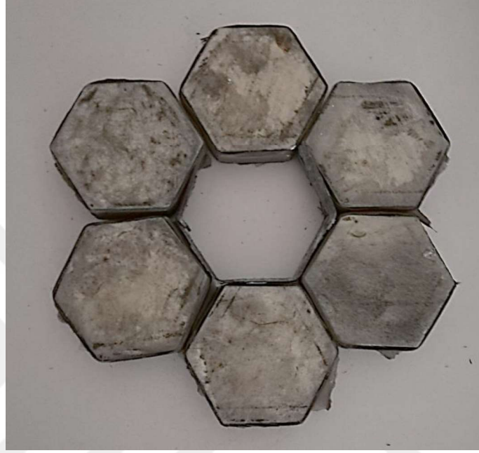
Şekil 3.12. 1,5 mm boşluklu numunenin mermi çarpması sonucu, çevre seramiklerin görünümü - 1
