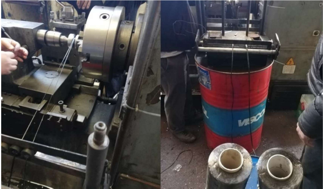
Şekil 3.1. Karbon liflerle sarımı yapılan alümina seramik
