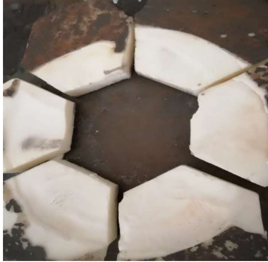
Şekil 4.9. Çevresi kompozit sargısız arası boşluksuz seramik ön yüzlü çelik zırhta çevre seramiklerin hasar durumu
