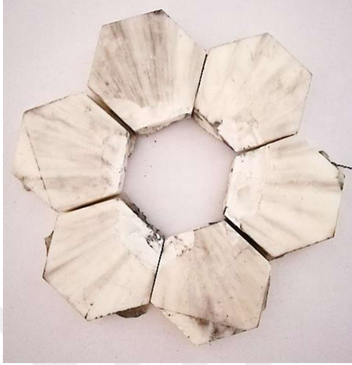
Şekil 3.6. Arası 1 mm boşluklu numunenin mermi çarpması sonucu, çevre seramiklerinde oluşan hasar durumu
