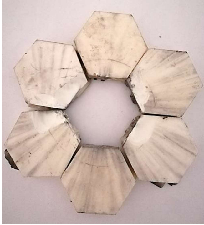
Şekil 3.5. Arası 1,5 mm boşluklu numunenin mermi çarpması sonucu, çevre seramiklerinde oluşan hasar durumu
