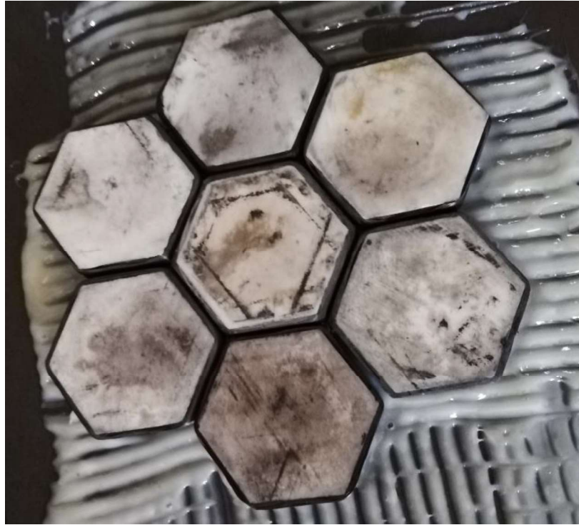
Şekil 3.9. Çevresi kompozit sargılı alümina seramik ön yüze sahipve arka yüzü hardox çelik sac olan zırh sistemine ait deney numunesi
