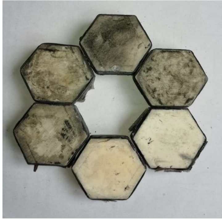
Şekil 3.11. 1 mm sarımlı hazırlanan numunenin mermi çarpması sonucu, çevre seramiklerinde oluşan hasar durumu
