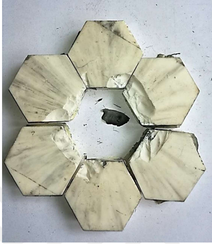
Şekil 3.10. 1 mm boşluklu numunenin mermi çarpması sonucu, çevre seramiklerinde oluşan hasar durumu
