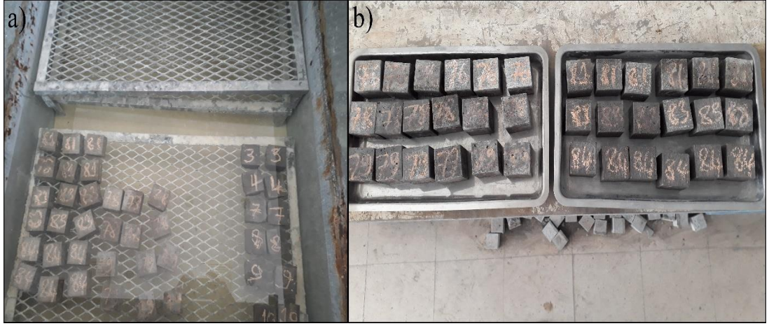
Şekil 5.1. a) 50×50×50 mm boyutlarındaki prizmatik çimento harçlarının sürekli su kürüne maruz bırakılmaları b) Kalıptan çıkartıldıktan sonraki görüntüsü
