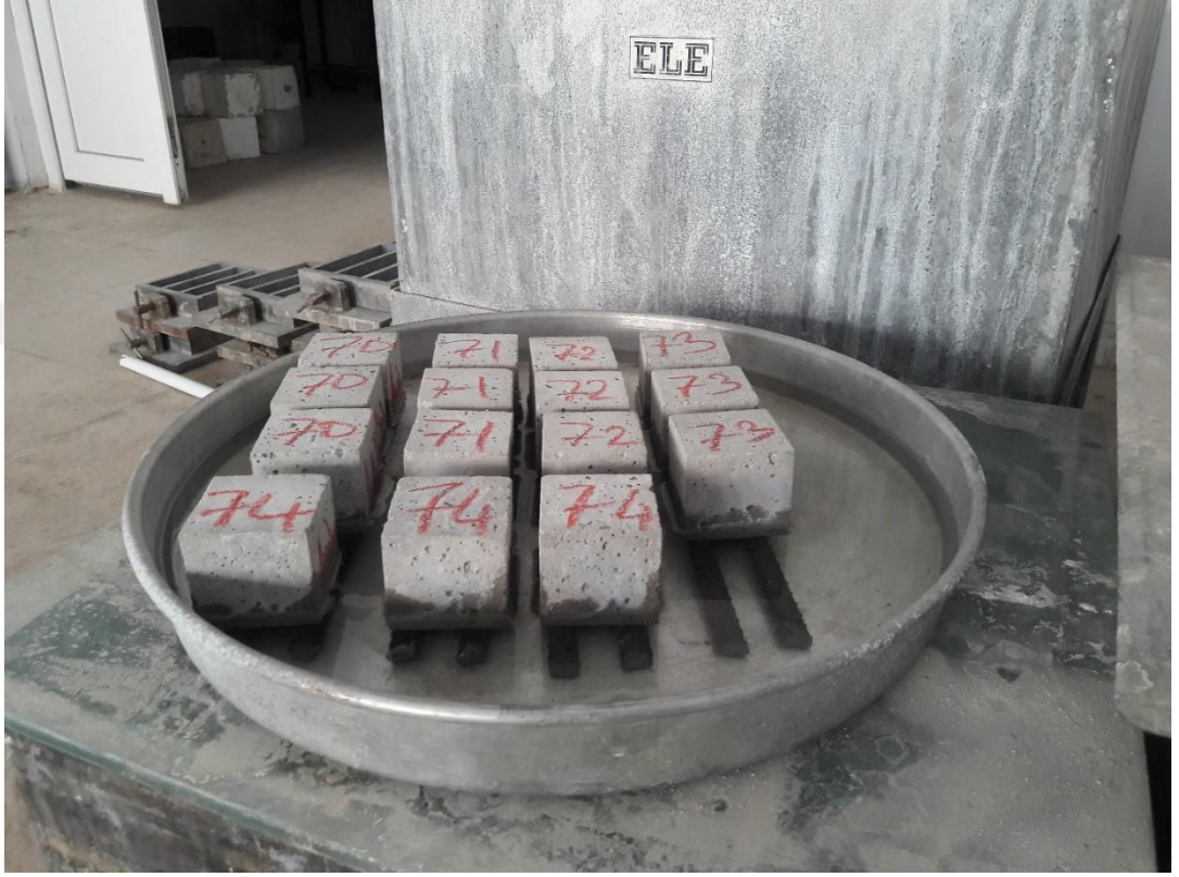
Şekil 5.21. Kılcal su emme katsayısı belirleme deney düzeneđi
