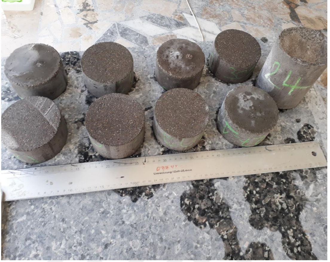
Şekil 5.28. Ø100×200 mm silindir çimento harçları orta kısımlarından olgunlaştırma sonrası 50 mm uzunluğunda kesilen hızlı klorür iyonu geçirimsizliği çimento harcı deney örnekleri
