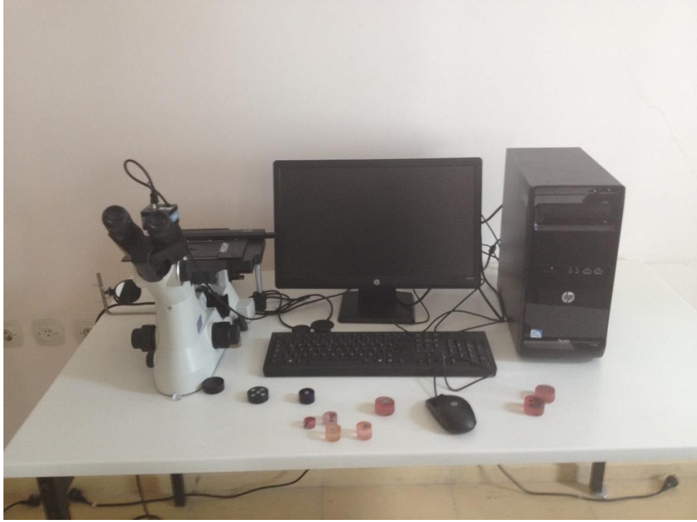
Şekil 3.2. Metal mikroskobu ve analiz bilgisayarının genel görüntüsü.
