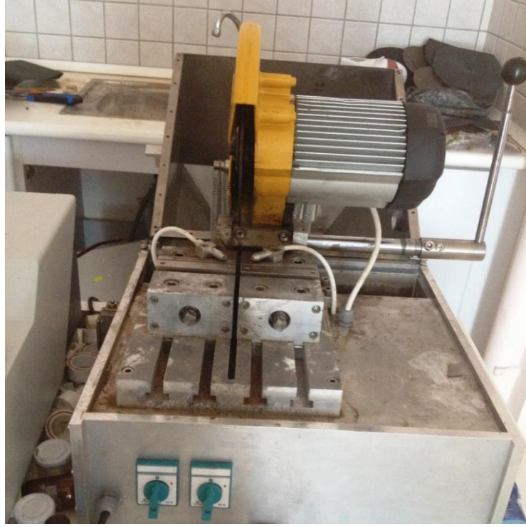
Şekil 3.4. Çelik örnekleme kesmek için kullanılan kesicinin görüntüsü
