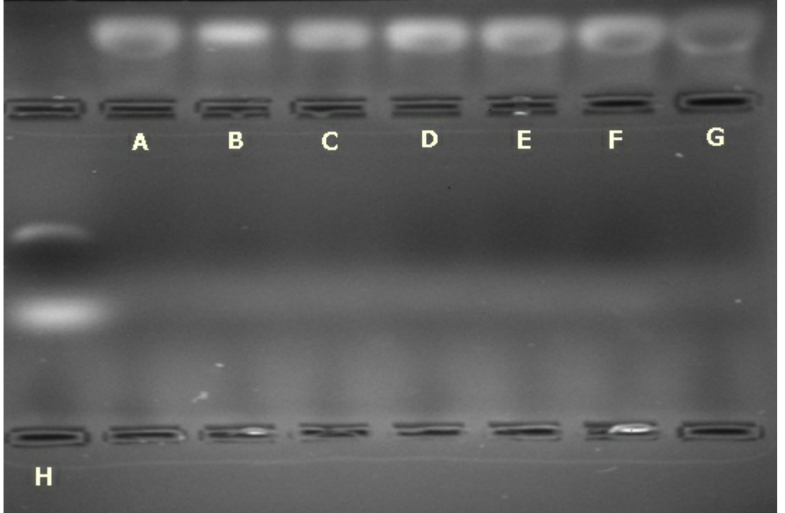
Şekil 4.8. Agaroz jel elektorforezinde yürütülen yalnızca AuNP, yalnızca siRNA ve AuNP+siRNA kompleksinin görüntüsü (A=1 \mu L siRNA +1 \mu L AuNP konulan kuyucuktaki ilerme, B=1 \mu L siRNA +2 \mu L AuNP konulan kuyucuktaki ilerme, C=1 \mu L siRNA +4 \mu L AuNP konulan kuyucuktaki ilerme, D=1 \mu L siRNA +8 \mu L AuNP konulan kuyucuktaki ilerme, E= 1 \mu L siRNA +16 \mu L AuNP konulan kuyucuktaki ilerme, F=1 \mu L siRNA
