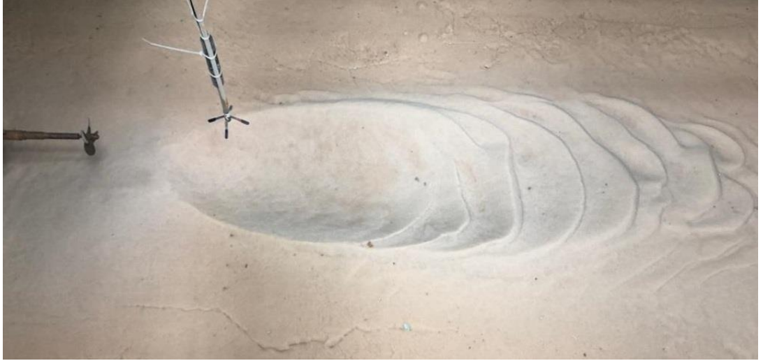
Şekil 3.4. Sınırlandırılmamış durumda denge oyulma profili
