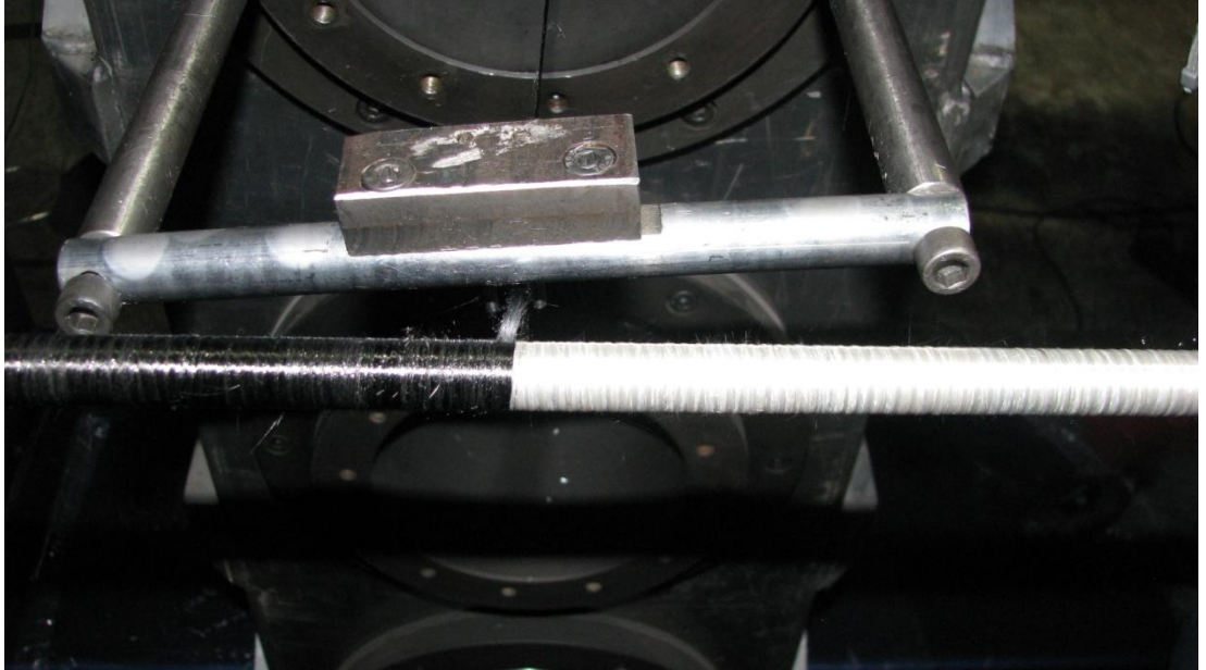
Şekil 3.11. Karbon/Epoksi sarım işlemi.
